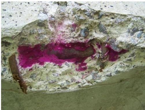
**Figura 3.5:** Profundidad de carbonatación en una estructura.
