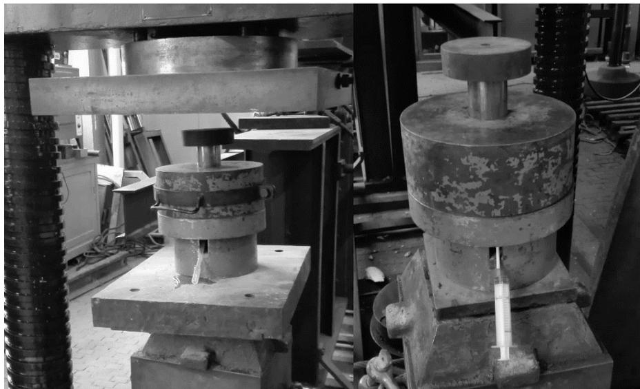
**Figura 3.1:** Dispositivo para extracción de solución de poro.
