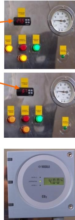
**Figura 3.9:** Detalle del registro continuo digital de temperatura y humedad relativa y concentración de CO<sub>2</sub> del interior de la cámara.
