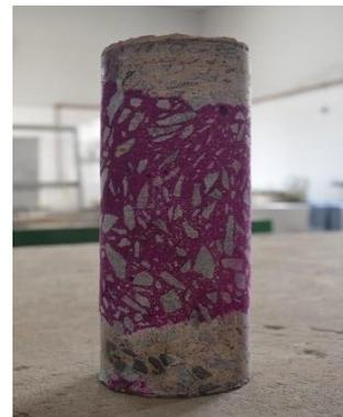
**Figura 3.6:** Profundidad de carbonatación sobre testigos del Edificio LEMIT: a) exterior, b) interior (columna).
