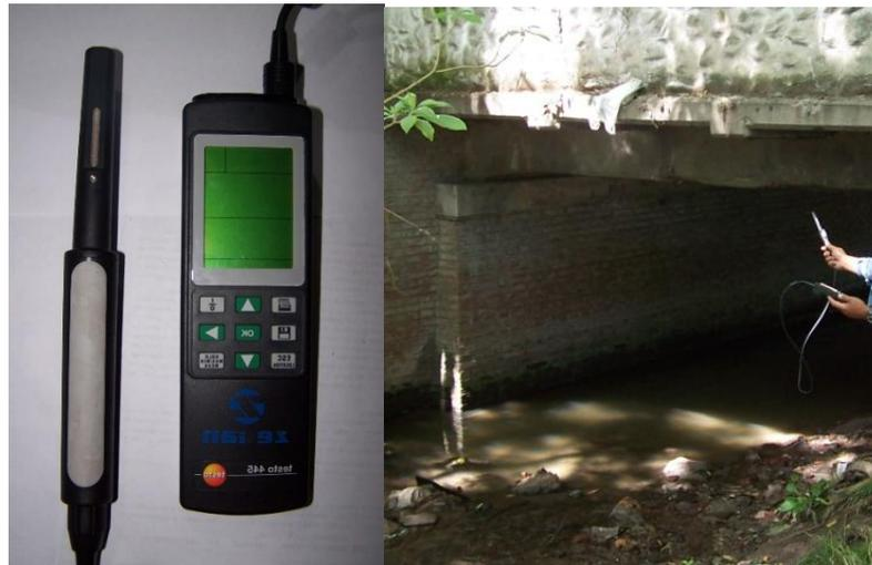
**Figura 3.3:** Medidor de CO<sub>2</sub> Testo 445. Mediciones con el equipo marca Testo.
