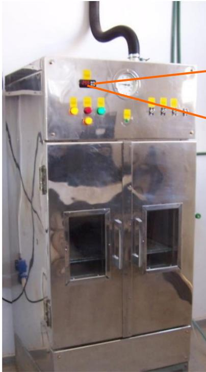
**Figura 3.8:** Vista de la cámara de carbonatación acelerada.
