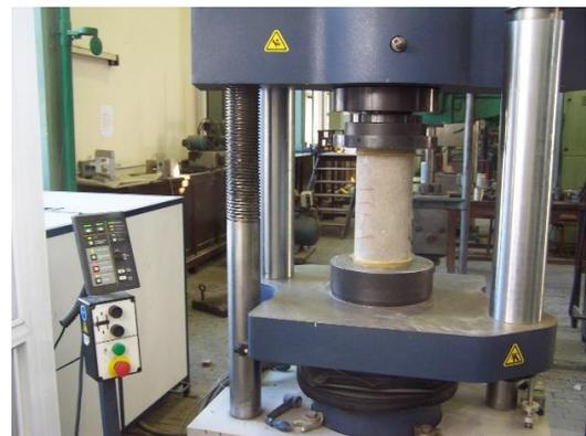
**Figura 3.7:** Extracción y ensayo de resistencia a compresión de testigos, en el edificio del LEMIT.
