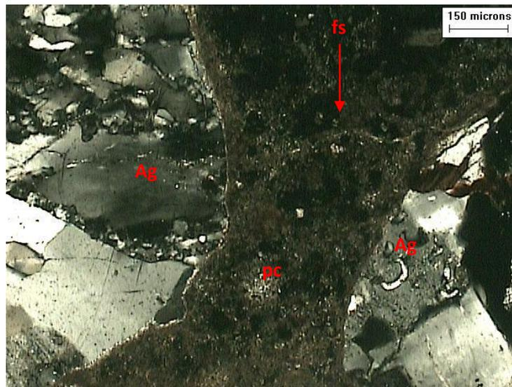
**Figura 3.15:** Imagen al microscopio (LEMIT). Se observa en los extremos de la imagen dos agregados gruesos (Ag) y en medio la pasta de cemento (pc) que los separa. Pequeña fisura (fs) que conecta ambos agregados. La interfaz pasta-agregado se aprecia carbonatada. Observación con polarizadores cruzados (50X).
