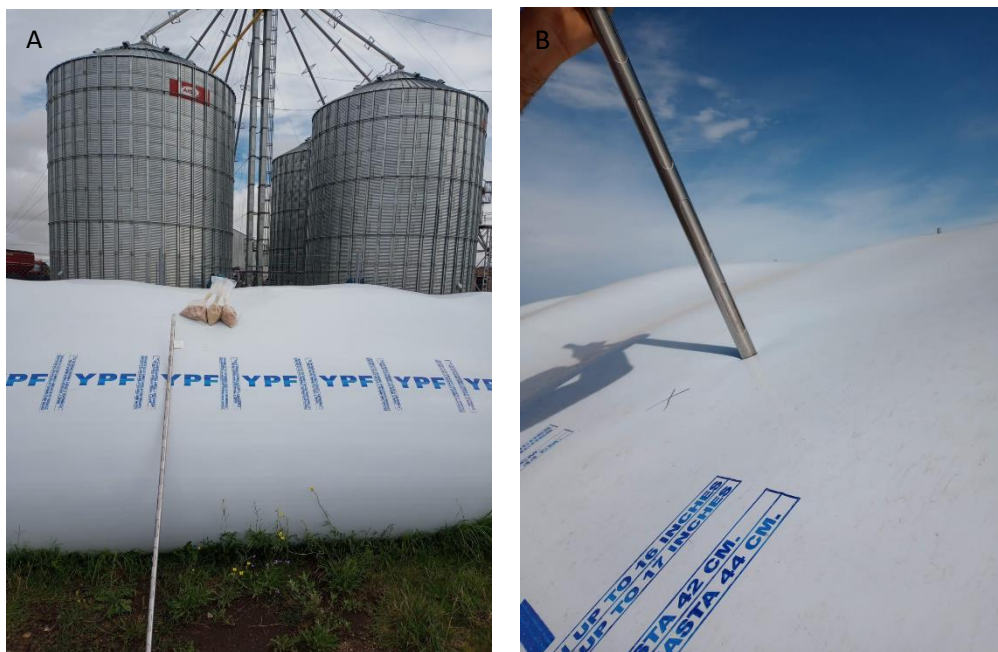
Figura 21: A: Vista frontal de calador y silobolsa. B: Vista lateral de calador en el silobolsa.
