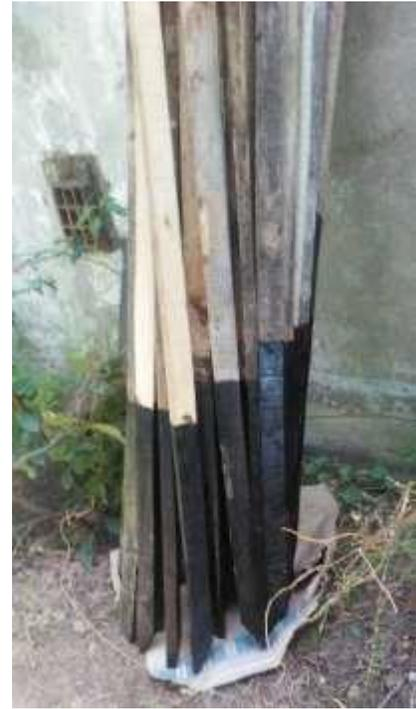
Figura 4: Pintado de Tutores de madera tratados con pintura asfáltica, para evitar su degradación una puestos en el suelo.
