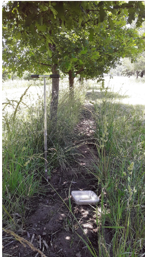
Figura 10. Muestreo de suelo mineral con barreno de la profundidad 0-20 cm para el tratamiento en hilera de robles de 11 años
