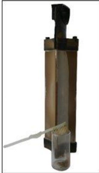
Figura 7. Placa de aluminio cargada de partículas PM10.
