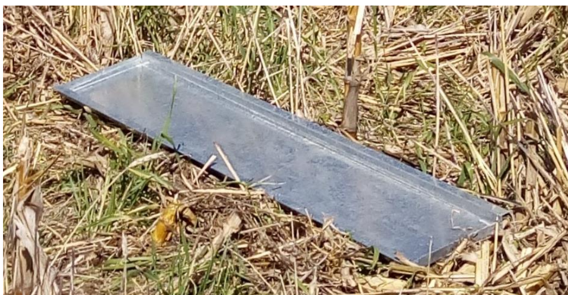
Figura 4. Bandeja utilizada para colectar las muestras de suelo.
