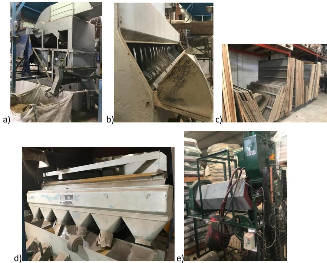
*Figura 40.* a y b) Distintas partes del sistema de limpieza. Ingresan las semillas del silo y salen las semillas limpias listas para el embolsado y venta. c) Zarandas intercambiables pertenecientes al sistema de limpieza. d) Mesa densimétrica, utilizada para separar las semillas según su peso específico. e) Máquina utilizada para la aplicación de curasemillas.
