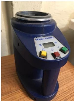
*Figura 11.* Humedímetro Tesma utilizado para la medición de humedad (%) de los granos de las distintas muestras.
