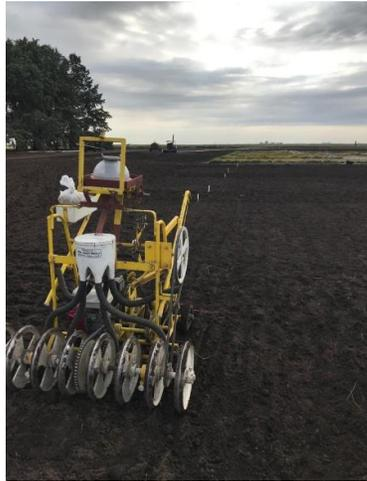
Figura 28. Máquina sembradora de 6 surcos, utilizada para la siembra de ensayos.
