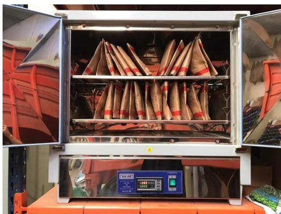
*Figura 25.* Sobres identificados con muestras en su interior, dentro de la estufa, listos para ser sometidos al secado.
