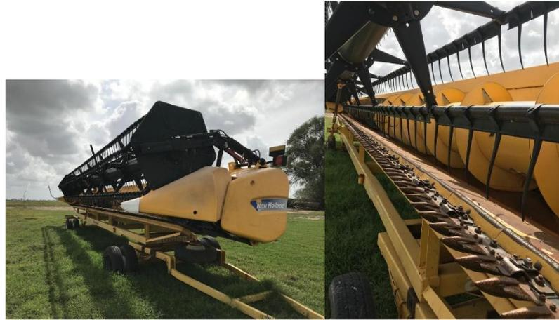
Figura 33. Cabezal para cosechadora de trigo y soja.
