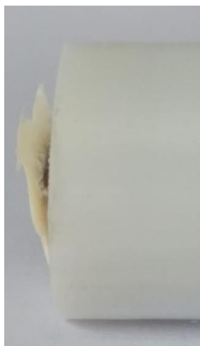
Figura 7.9. Fotografía del recubrimiento EP aplicado sobre electrodos de Mg AZ91D luego de 3 días de inmersión en solución de Ringer.
