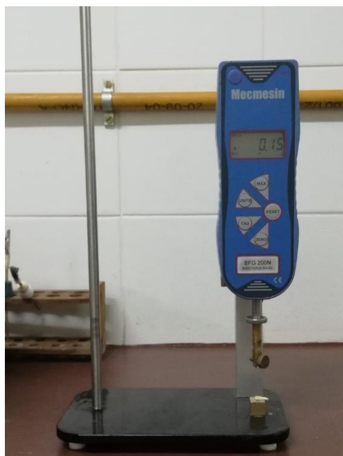
Figura 2.11. Medidor de la fuerza de adherencia Mecmesin (BFG 200N).
