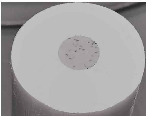
Figura 8.15: Fotografía del sustrato recubierto con RCE-EP(1) luego de 35 días de inmersión en solución de Ringer a 37 °C.
