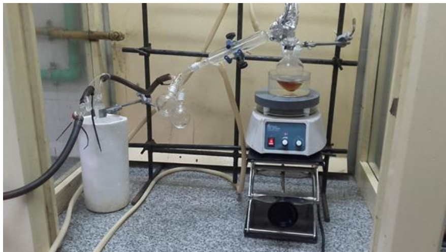
Figura 2.2. Sistema de destilación de Py. Consiste en un tren simple de destilación conectado a una trampa y una bomba de vacío (que no se llega a apreciar en la imagen).
