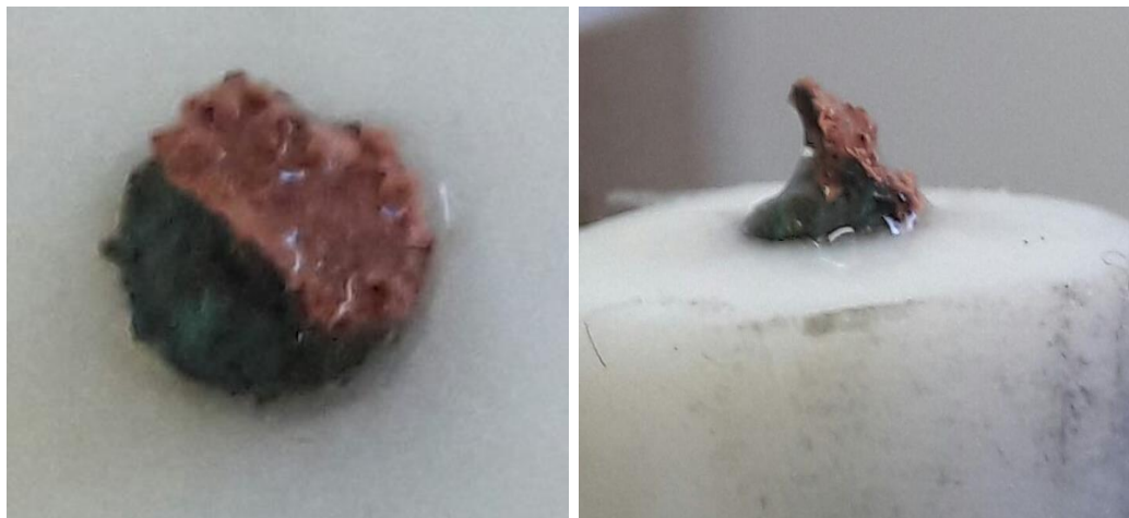
Figura 5.15. Fotografías de electrodos de Mg AZ91D recubiertos con RCE-HAsc/PPy luego de ser sumergido durante pocos minutos en soluciones 0,001, 0,010 y 0,100 M \text{CuSO}_4 .
