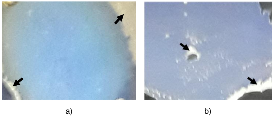
Figura 3.50. T = 21\text{ }^{\circ}\text{C} . Observados en reflexión, fotografía común. Las flechas señalan las partes que cristalizan, principalmente en los bordes. Área: 4 \times 6\text{ mm} . a) Dímero 6Y-3 . b) Dímero 8Y-3 .
