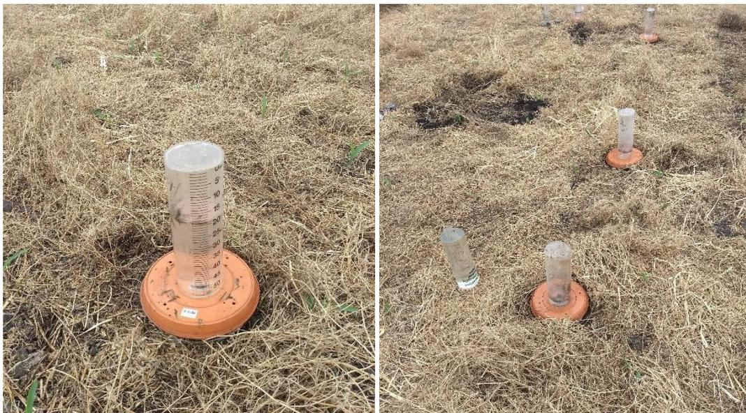
**Figura 4.** Determinación de la conductividad hidráulica saturada en las parcelas del ensayo de CC en la EEA Naredo.
