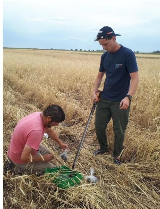
**Figura 5.** Toma de muestras con barreno para determinar raíces unidad vol de suelo<sup>-1</sup>.
