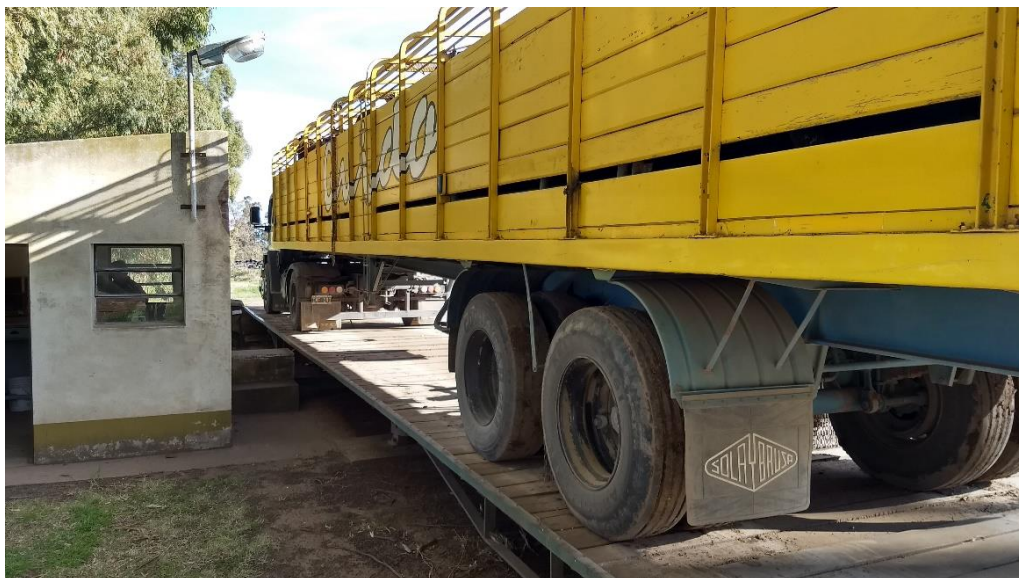
Figura 20. Camión sobre la balanza durante el registro del peso en bruto.
