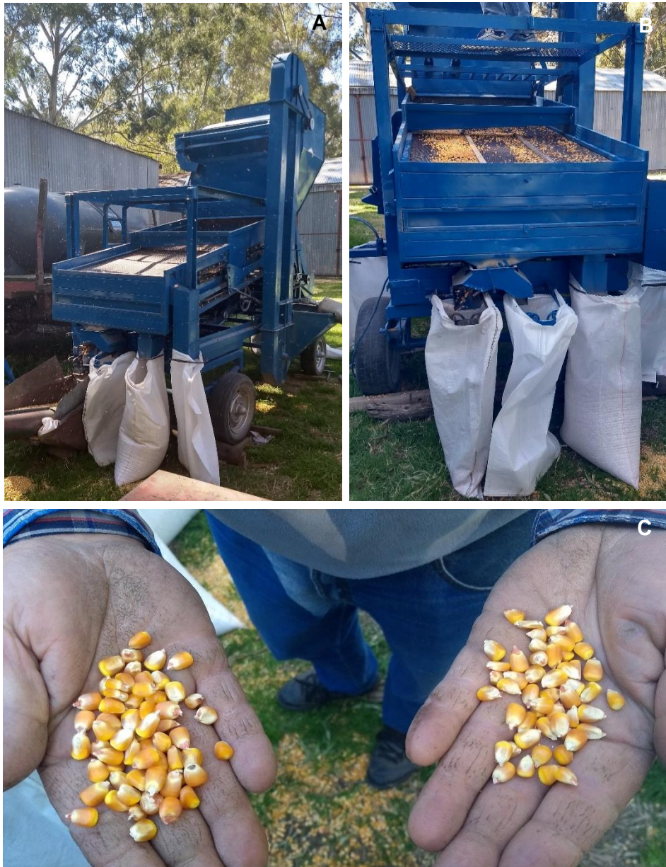
Figura 26: A-B: Máquina clasificadora utilizada para el acondicionamiento de los granos. C: Cariopses de maíz “grandes” y “chicos” luego de la separación con zarandas.
