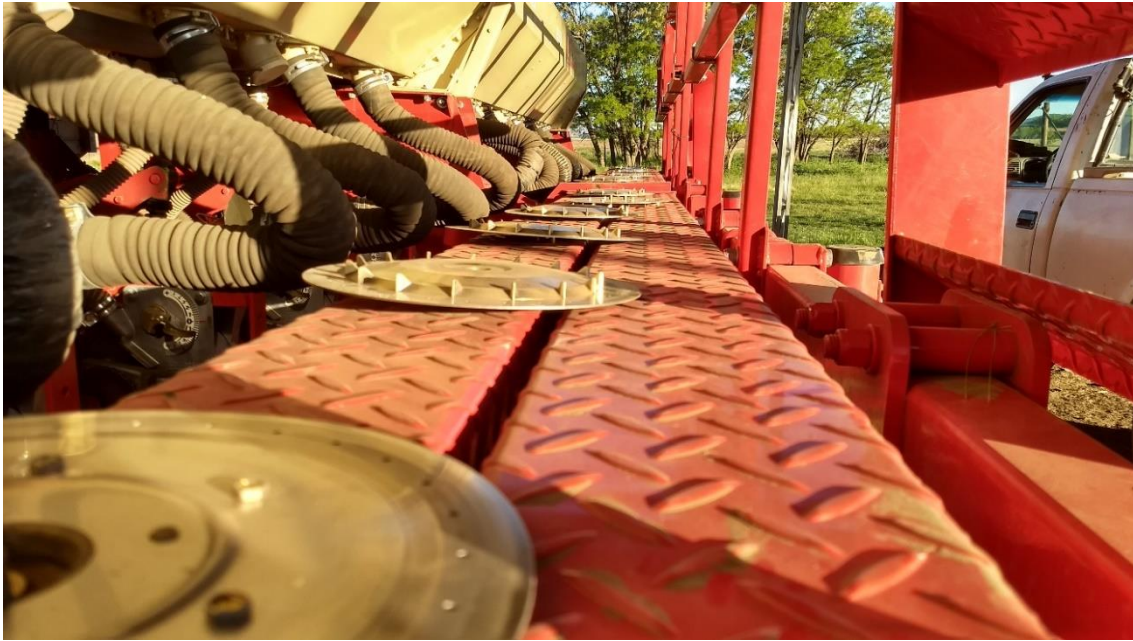
Figura 37. Cambio de las placas dosificadoras en la sembradora Giorgi.
