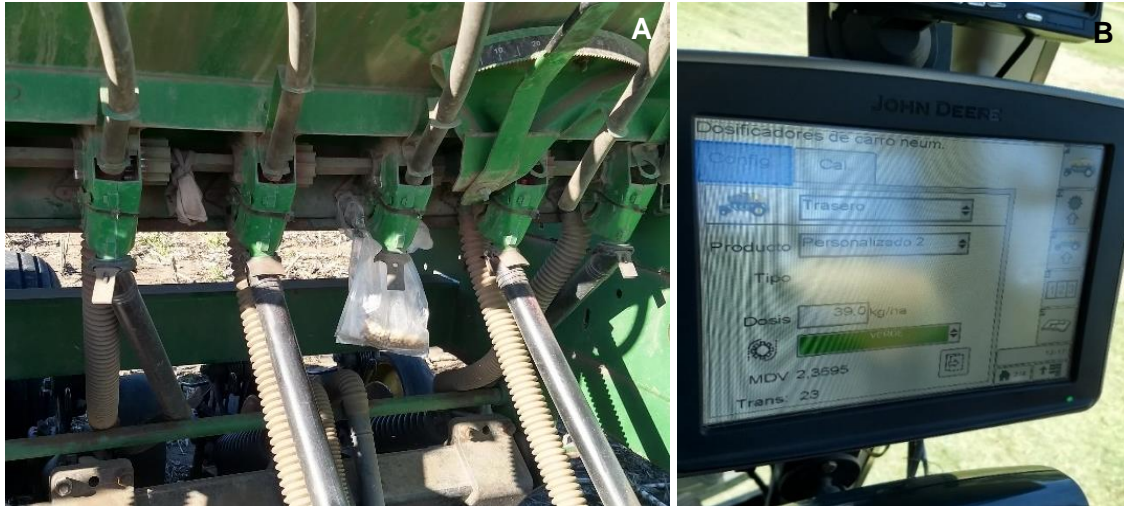
Figura 30. Tareas de calibración de la sembradora para soja a chorrillo. A: Toma de muestra con una bolsa colocada en un tubo de bajada; B: Pantalla del monitor de la sembradora JD 1910 durante la calibración.
