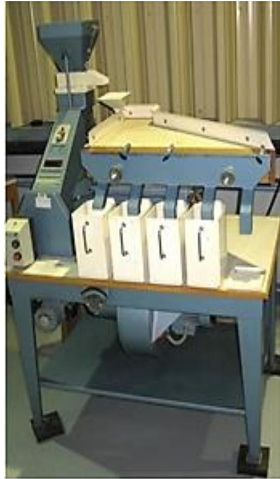
*Figura 33. Mesa densimétrica utilizada para limpiar completamente las muestras de cipselas de guayule.*
