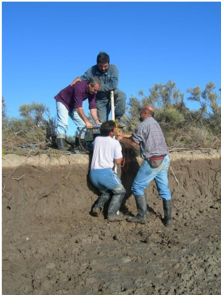
Fig. 34: Hincado con vibrocoring.
