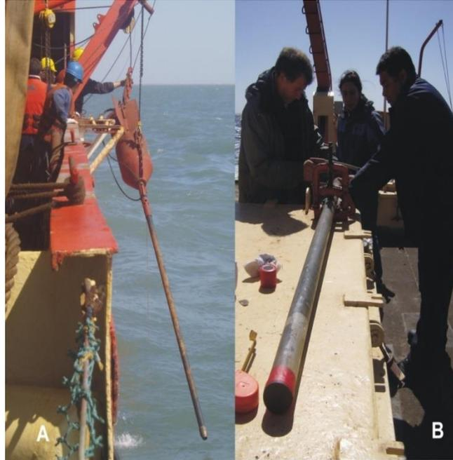
Fig. 44: A) Momento de la extracción, y B) Fraccionamiento para mejor un almacenamiento posterior del testigo PD24
