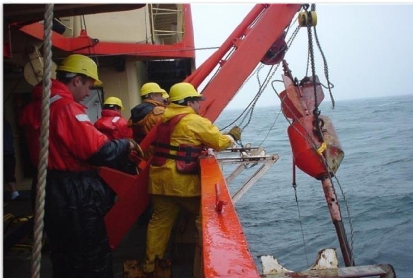
Fig 10: PD24. Extracción del testigo PD24 mediante sacatestigos gravedad - pistón.
