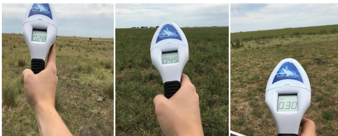
Figura 7. Dispositivo Greenseeker utilizado para calcular el Índice de Vegetación de Diferencia Normalizada (NDVI) en las recorridas a campo. Fotos propias.
