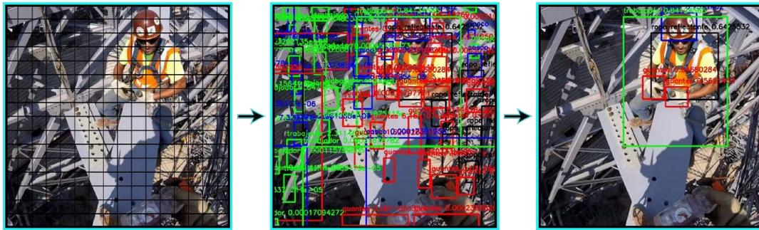
Figura 3.4: Proceso Propuesto, de izquierda a derecha: (1) dividir en bloques de 13x13, (2) hacer predicciones con YOLO re-entrenado y (3) establecer umbrales para obtener solo las detecciones más confiables.
