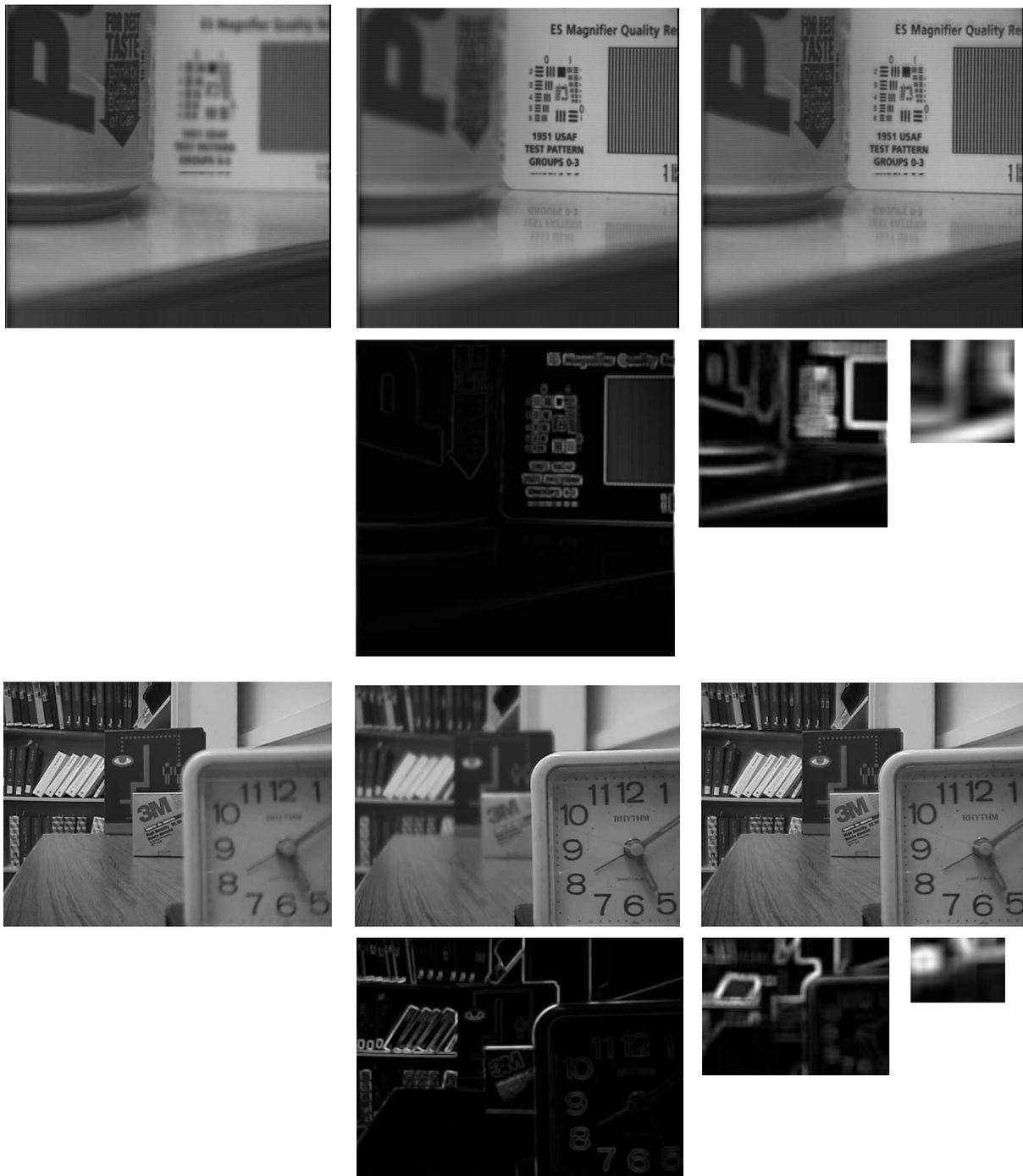
Figura 5.2: Imágenes de entrada multi-foco: “Pepsi” y “Disk” (foco a izquierda y foco a derecha) y la imagen fusionada obtenida por el método SIDWT junto a sus respectivos mapas de calidad para  $L = 1, 3$  y 5. El brillo indica la magnitud de  $MS-Q_W$ .
