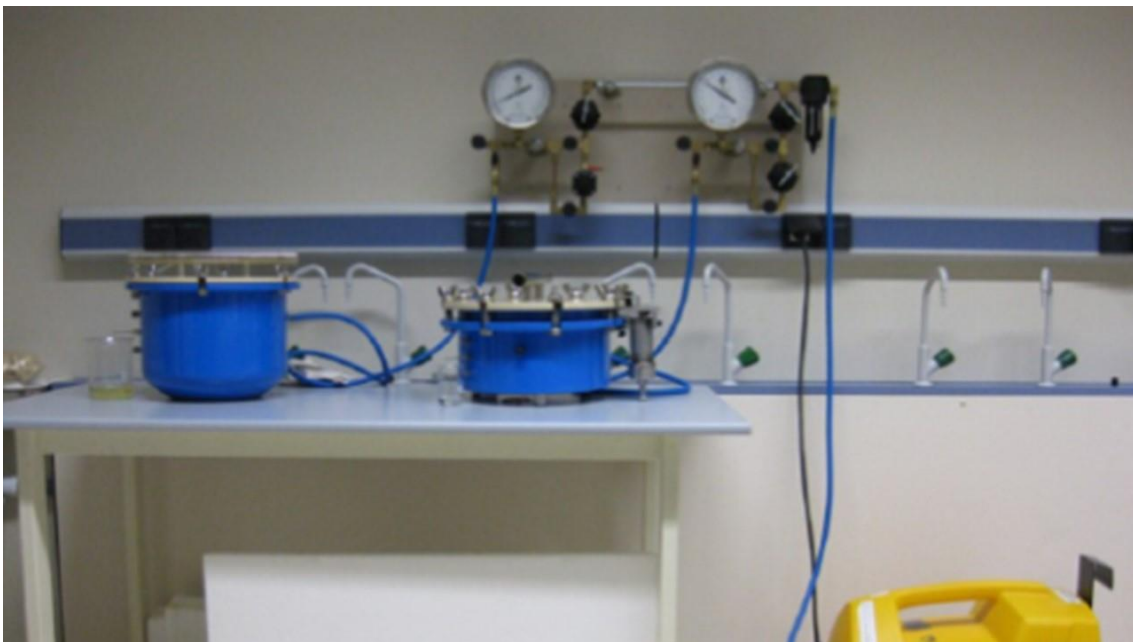
Figura 10. Equipos de tensión de Richards.
