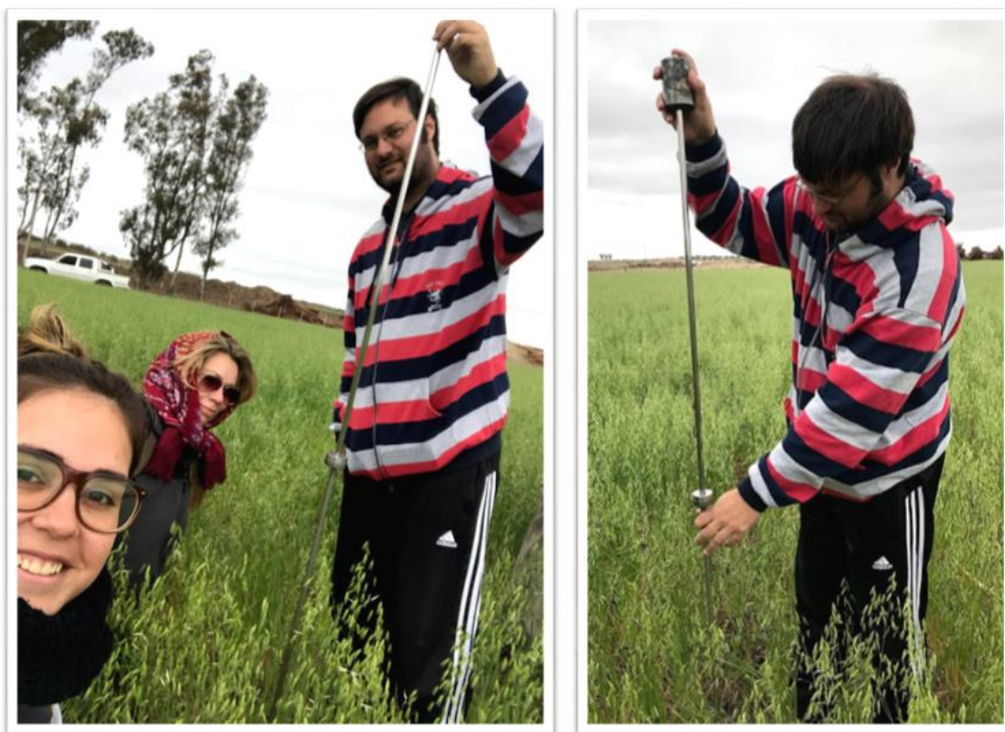
Figura 12. Detalle del uso del penetrómetro de golpe en el ensayo.
