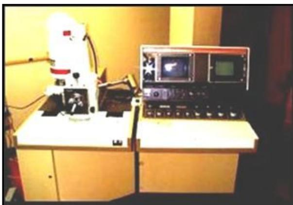
Fotografía 2.6. Microscopio electrónico de barrido Jeol JSM-35CF.
