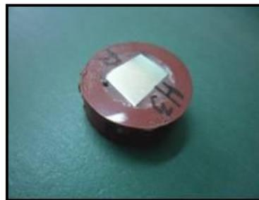
Fotografía 2.3. Muestra montada en base polimérica.
