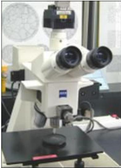
Fotografía 2.5. Microscopio óptico Marca Zeiss de 1000X.
