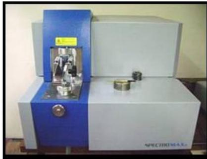
Fotografía 2.4. Espectrómetro de emisión ESPECTROMAX modelo X.
