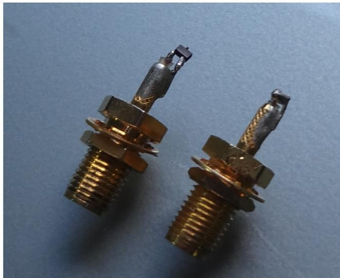
**Figura 3.5:** Conectores SMA utilizados en la medición de la impedancia del chip en función de la potencia. El conector sobre el lado izquierdo tiene en su extremo el chip RFID y el del lado derecho un cortocircuito.
