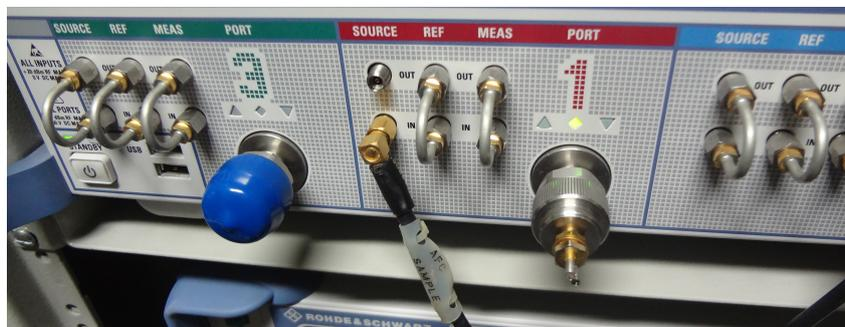
**Figura 3.8:** Fotografía del panel frontal del analizador vectorial. Se muestra la remoción del puente que permite el reemplazo del generador interno por el generador de señales externo.
