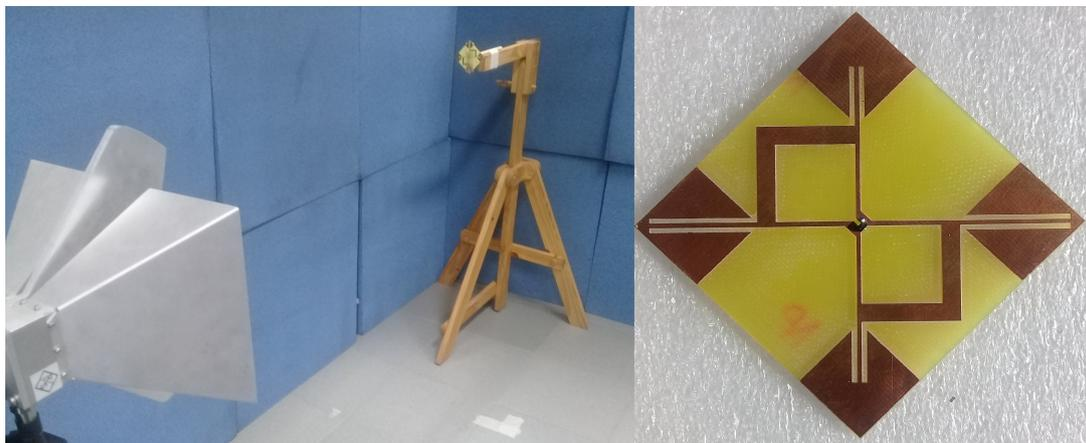
**Figura 6.8:** Medición del rango del *tag* con un equipo lector Alien ALR 9990+ y una bocina con polarización lineal. La fotografía de la derecha muestra el *tag* armado con el chip Alien Higgs 4 (encapsulado SOT-323) y la antena.
