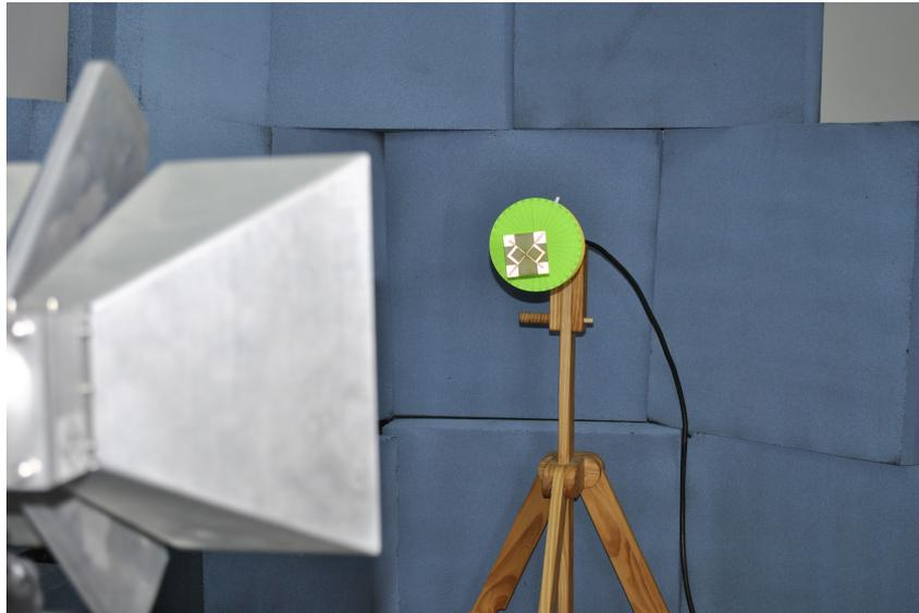
**Figura 6.5:** Medición del AR de la antena. La antena se conectó al analizador de espectro a través del balun y se iluminó con una onda polarizada linealmente.
