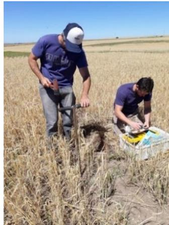
**Figura 9: Fotografía de la toma de muestras con barreno para determinar humedad gravimétrica a cosecha.**
