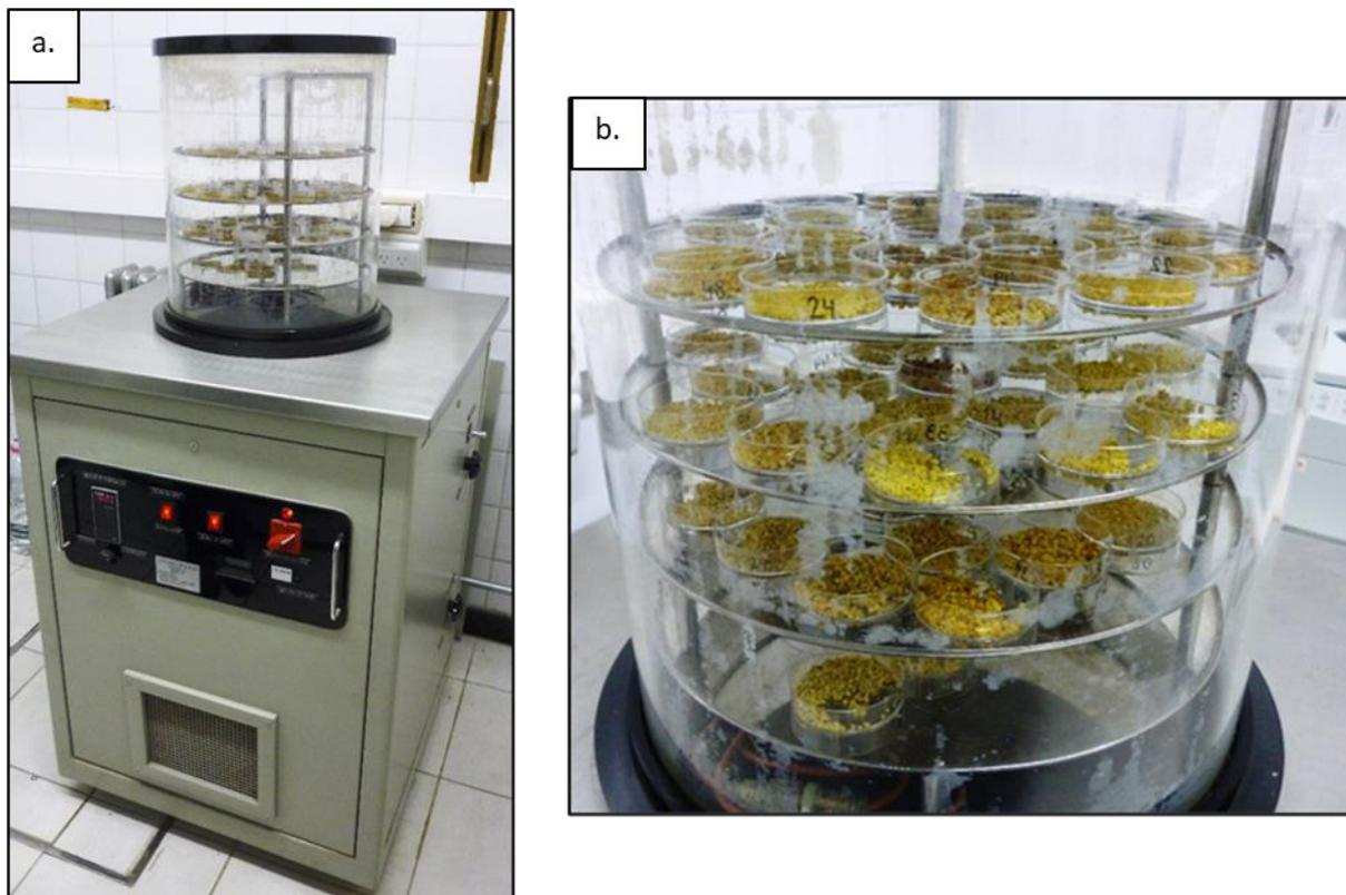
**Figura 4.2.** a. Liofilizador Rificor L-A-B4 (LIUC-UNS). b. Detalle del procesamiento de muestras. Fuente: propia.
