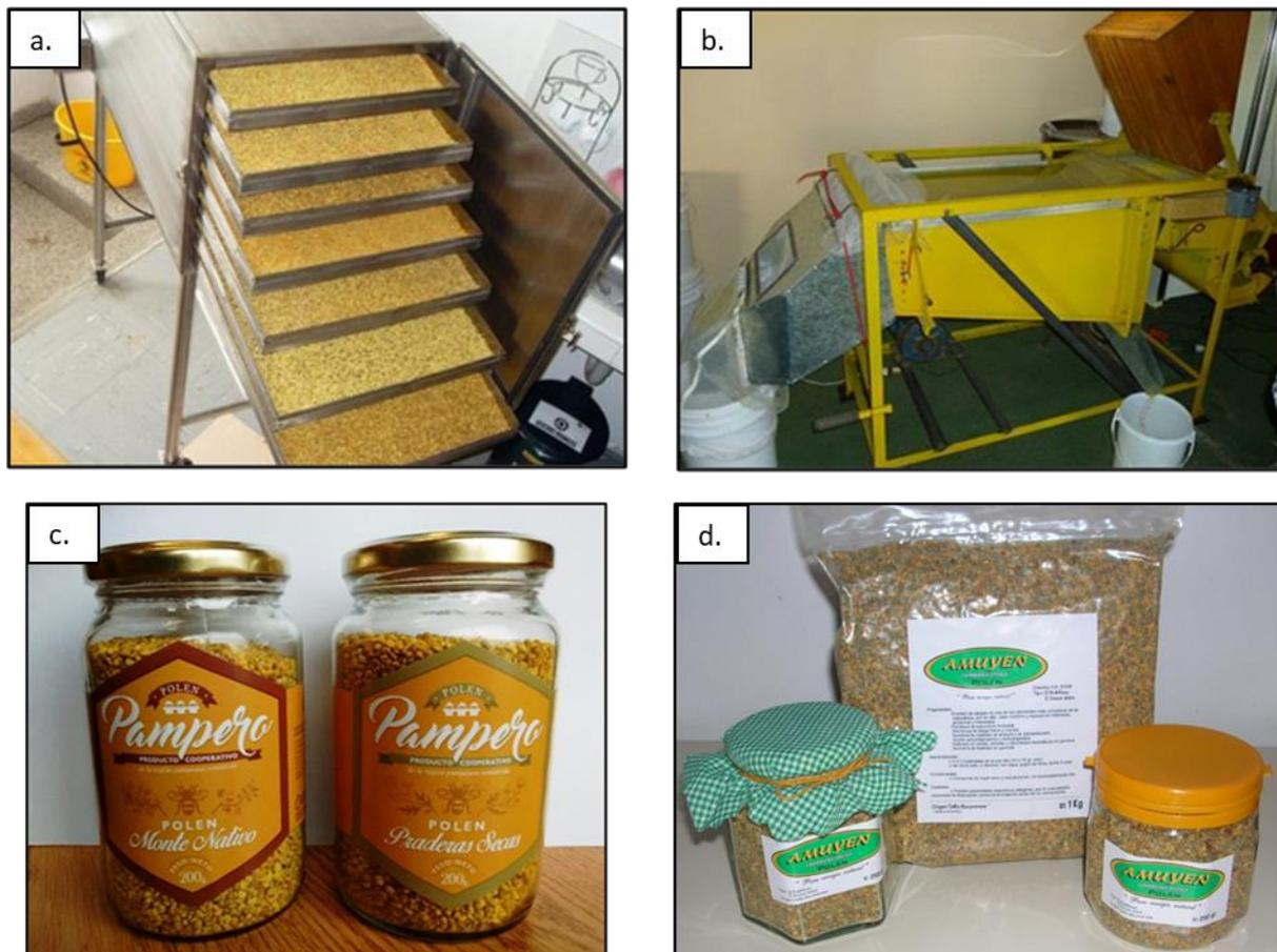
**Figura 1.6.** Procesamiento poscosecha de polen. **a.** Secado: modelo de una secadora de polen. **b.** Limpieza: máquina limpiadora de polen (diseño de un productor de polen de Jacinto Arauz). **c.** y **d.** Envasado: diferentes presentaciones comerciales. Fuente: a. <http://edmundofgabus.blogspot.com.ar>; b. y c. propia; d. Angel Dovicó (Cooperativa Amuyén).
