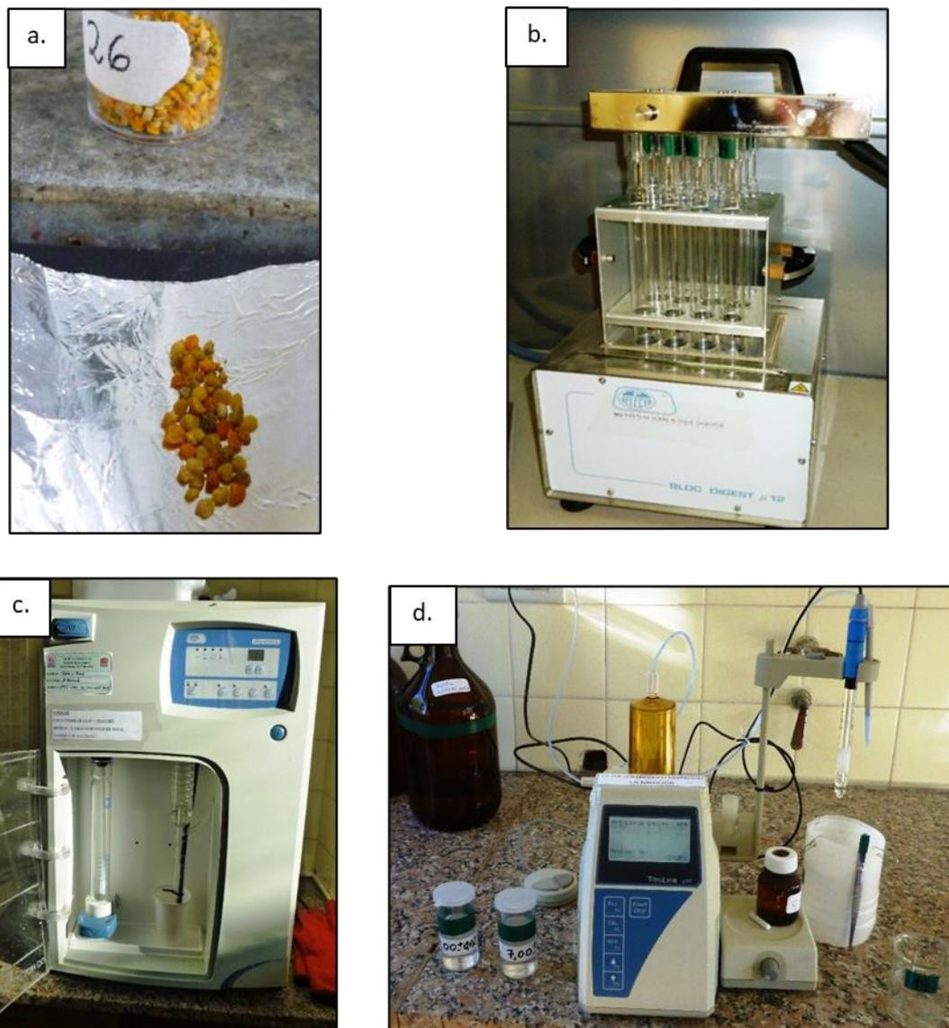
**Figura 4.3.** Determinación de proteínas totales (Laboratorio de suelos EEA INTA H. Ascasubi). **a** Muestra de polen. **b.** Bloque digestor Selecta. **c.** Destilador Pro-Nitro S. **d.** Titulador automático Titro Line Easy. Fuente: propia.
