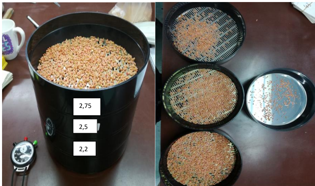
Figura 6: Sistema de tamices ensamblados para la determinación del calibre de la semilla.
