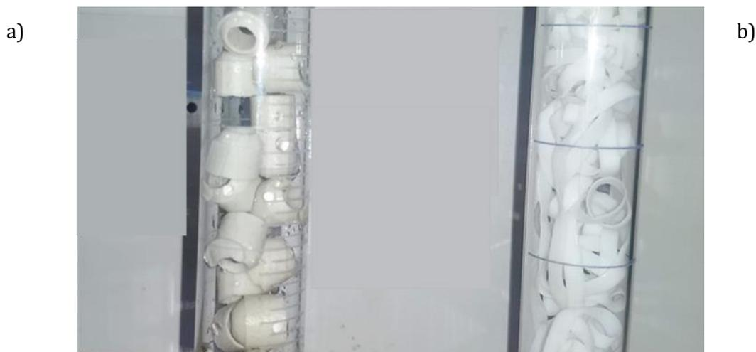
Figura 7.6. Rellenos utilizados en esta tesis en columnas de vidrio de diámetro equivalente al de la columna de fraccionamiento utilizada.
