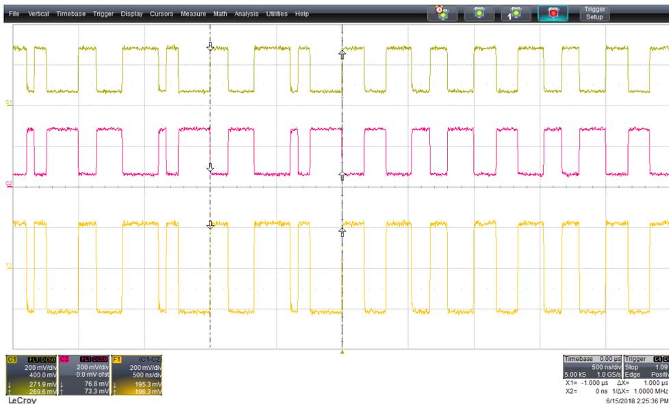
Figura 7.18: Señales PWM diferenciales,  $v_{out}^+$  (arriba) y  $v_{out}^-$  (centro), y señal combinada  $v_{out}$  (200 mv/div, 500 ns/div).
