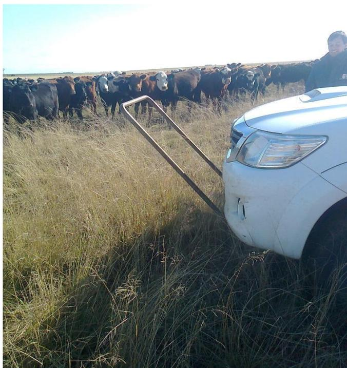
Foto 7 y 8. Accesorio en el vehículo para paso por los alambres eléctricos
