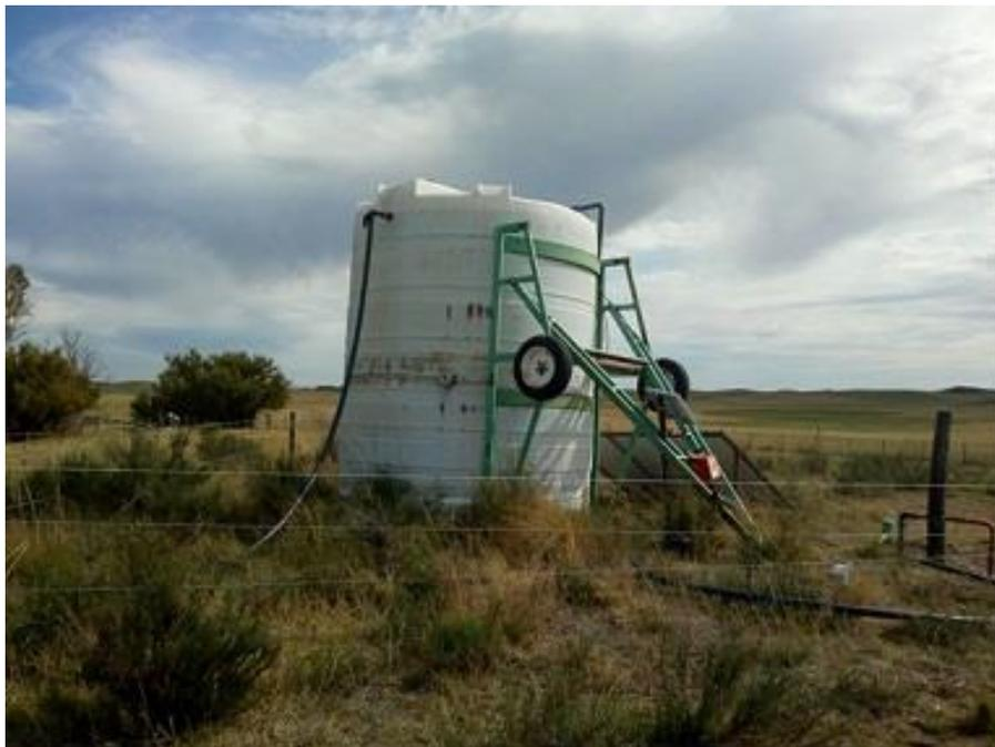
Foto 58. Tanque plástico de agua sobre carro con ruedas.
