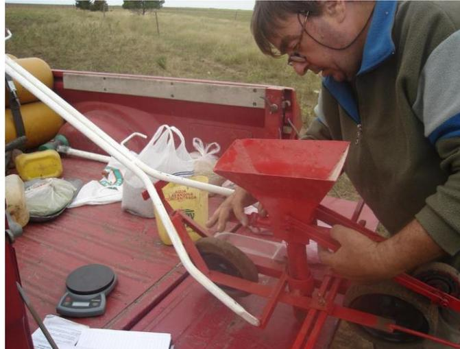
Foto 44. Calibración de la dosificación
