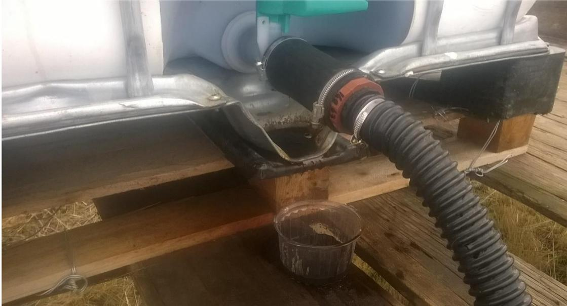
Foto 21. Acople con manguera corrugada para la dosificación de melaza desde el contenedor.
