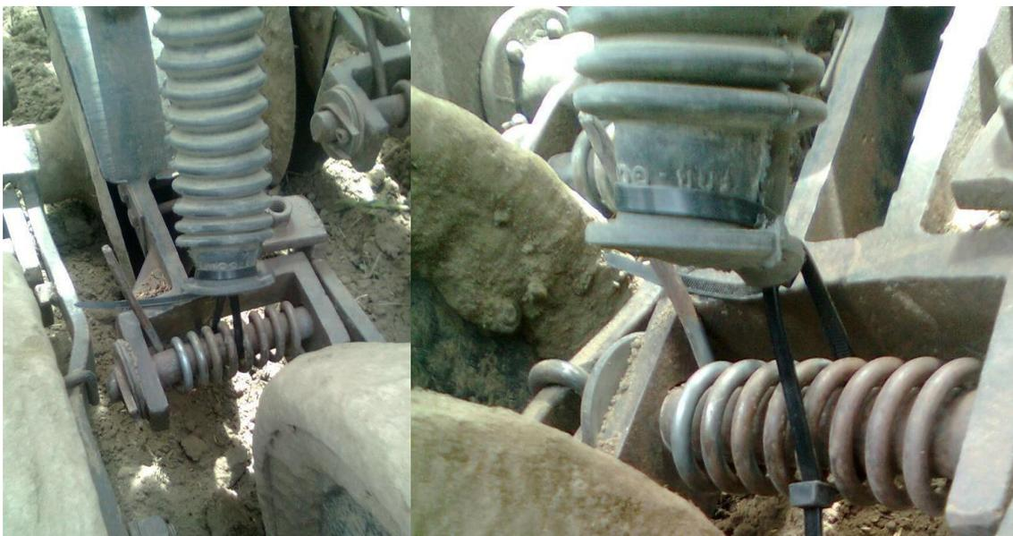
Foto 48. Mangueras precintadas en el soporte antes de la rueda compactadora.
