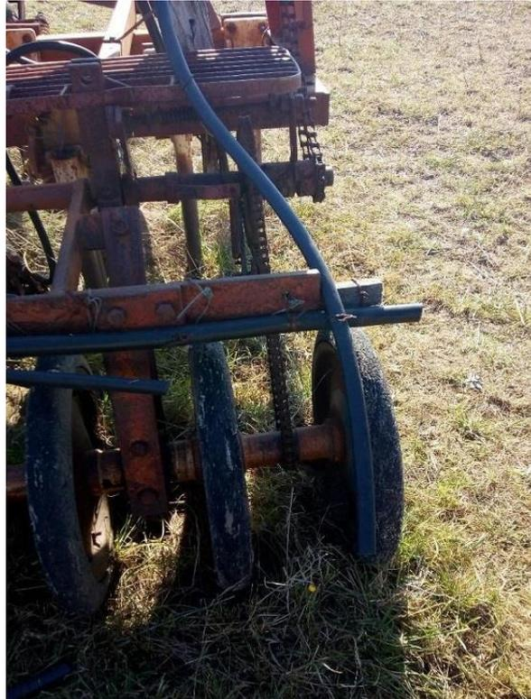
Foto 46. Altura al piso de la descarga de semillas.
