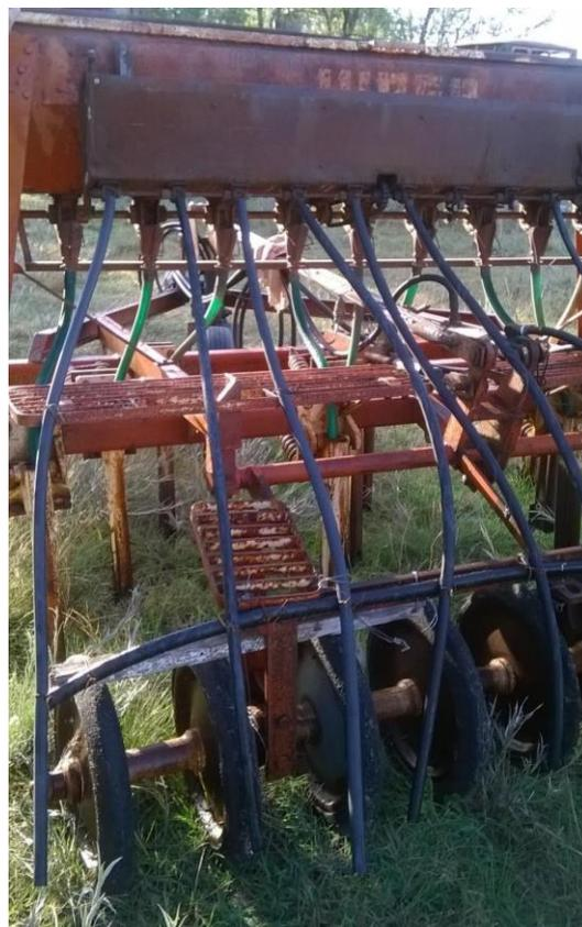
Foto 45. Sembradora de surco profundo, con modificaciones de los tubos de bajada.
