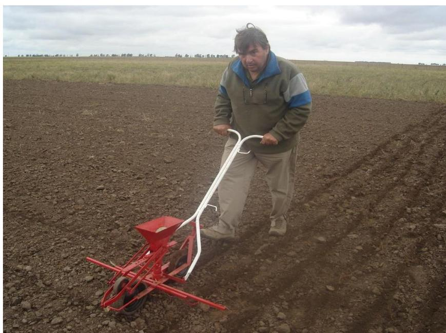
Foto 43. Prototipo de sembradora manual monocuerpo
