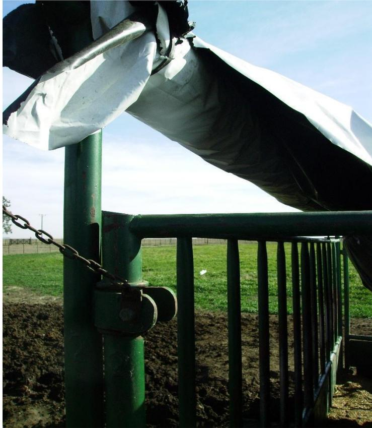
Foto 51. Mecanismo para enrollar la bolsa del silo.
