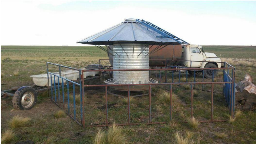
Foto 60. Silo de autoconsumo, con rejas limitadoras de paso de animales grandes, junto con bebederos portátiles y camión cisterna.
