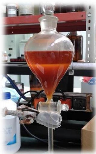
**Figura 4.** Ampolla de decantación que muestra la separación de compuestos entre dos solventes de diferente polaridad. En este caso, se observa la partición del extracto metanólico (fase inferior) con el solvente acetato de etilo (fase superior).
