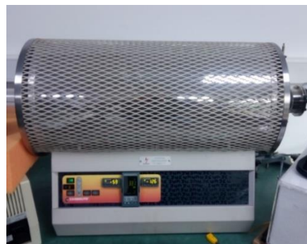
Figura 3.6.3: Horno Carbolite TZF para hacer medidas de impedancia a altas temperaturas.
