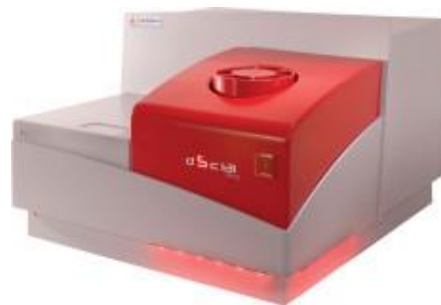
Figura 3.3.3.2: Equipo 131 Evo para medidas de DSC.
