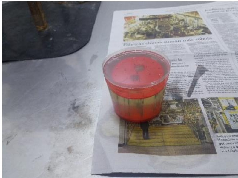
Figura A4: Incorporación dentro de recipiente contenedor y adición de resina
