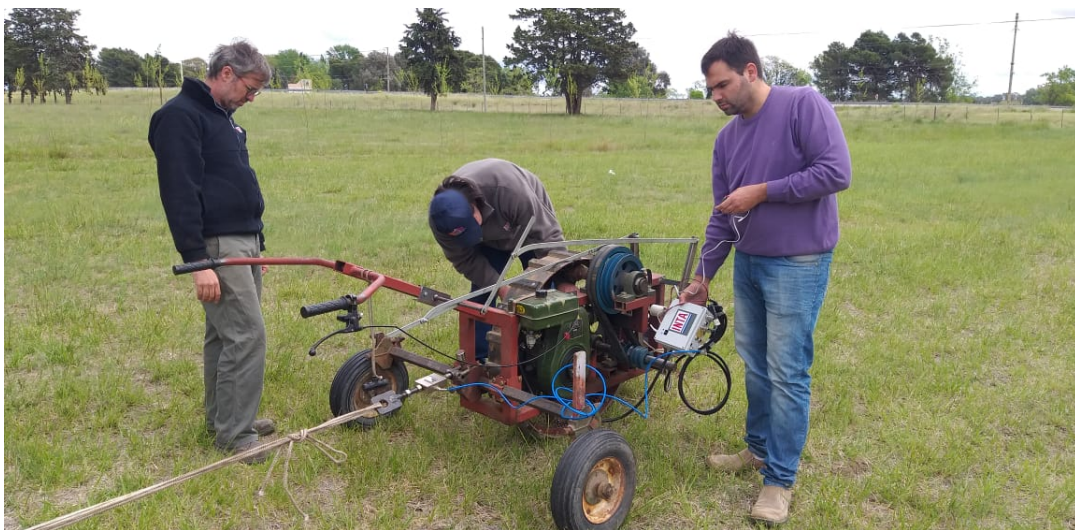
Figura 3.4: Empleo del registrador desarrollado para medir potencia de tiro y deslizamiento de correas de un microtractor multipropósito.
