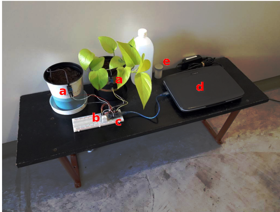
Figura 8.1: Arreglo del instrumental de adquisición de datos utilizado. (a) sensores de humedad de suelo, (b) sensores de humedad, temperatura y presión atmosférica, (c) microcontrolador, (d) computadora personal.
