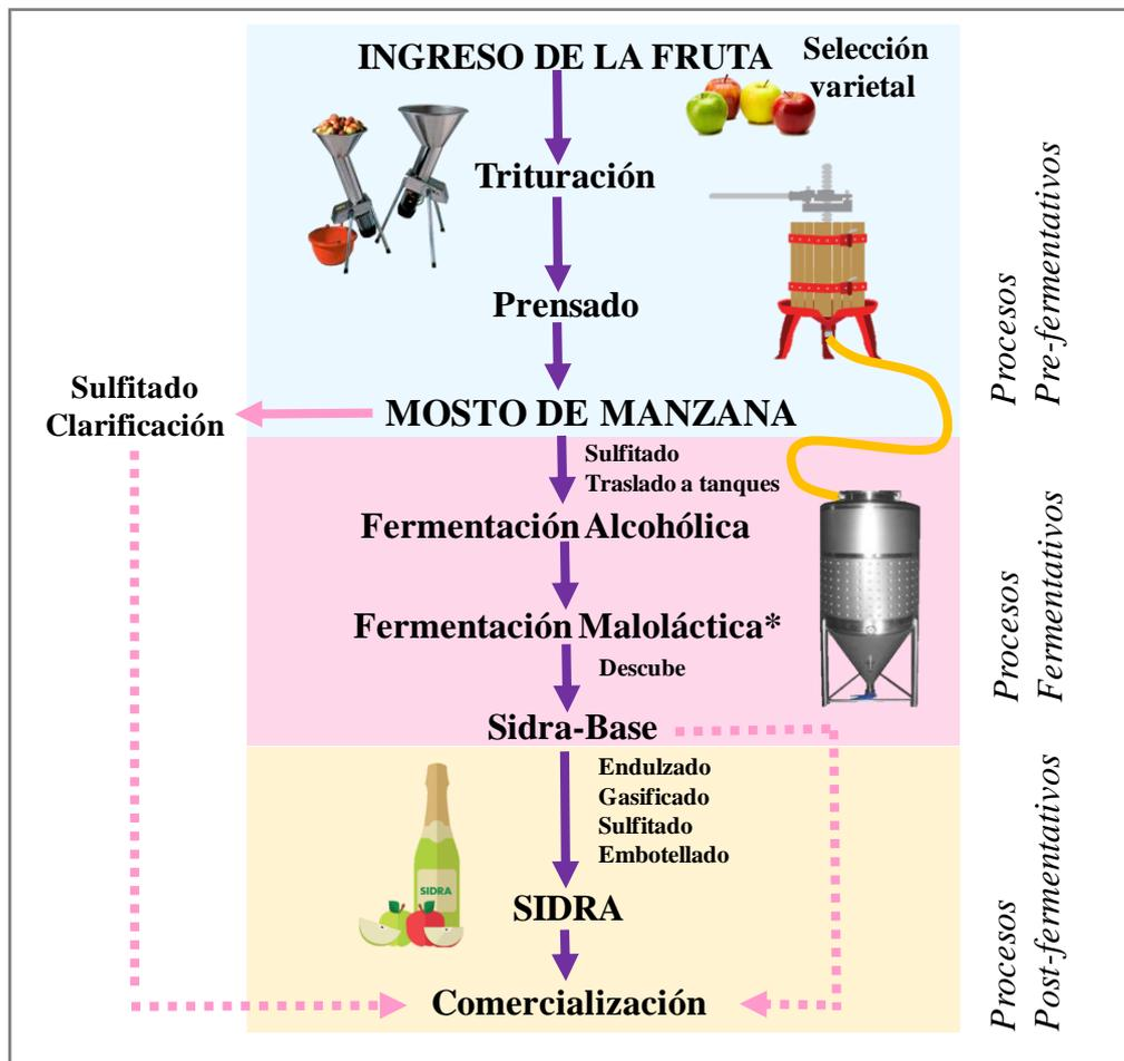
**Figura 6.2.** Esquema del proceso de producción de sidra. Extraído y adaptado de [Gonzalez Flores \(2019\)](#).
