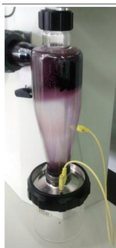
**Figura 4.5.** Procesamiento sin uso de adyuvantes de secado: vista del producto caramelizado adherido a las paredes del ciclón (rendimiento nulo).
