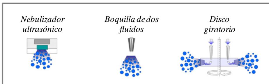
**Figura 1.3.** Diferentes tipos de atomizadores. Extraído y adaptado de Nandiyanto y Okuyama (2011).
