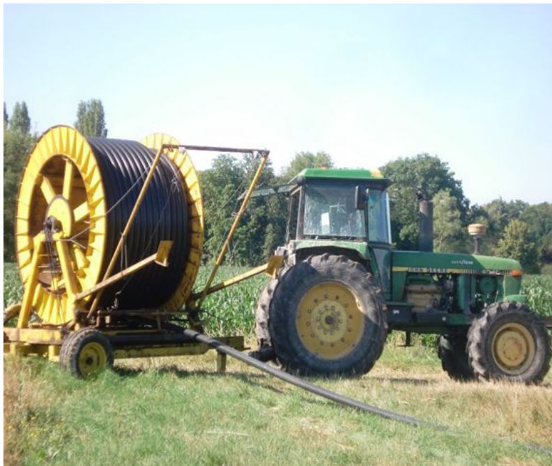
Fig. 19. Tractor y enrollador para riego. Fuente: F. Hirsfeld
