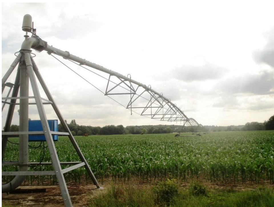
Fig. 17. Sistema de riego por pivot central en la S.C.E.A. Quillet. Fuente: F. Hirsfeld.
