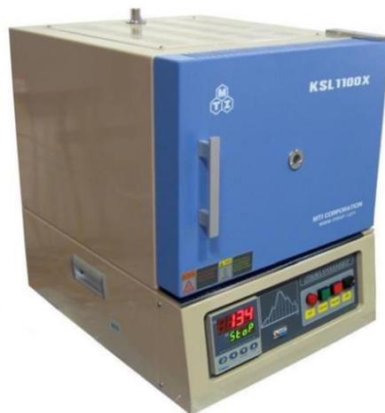
**Figura 3.23.** Imagen horno KSL-1100 X para altas temperaturas.
