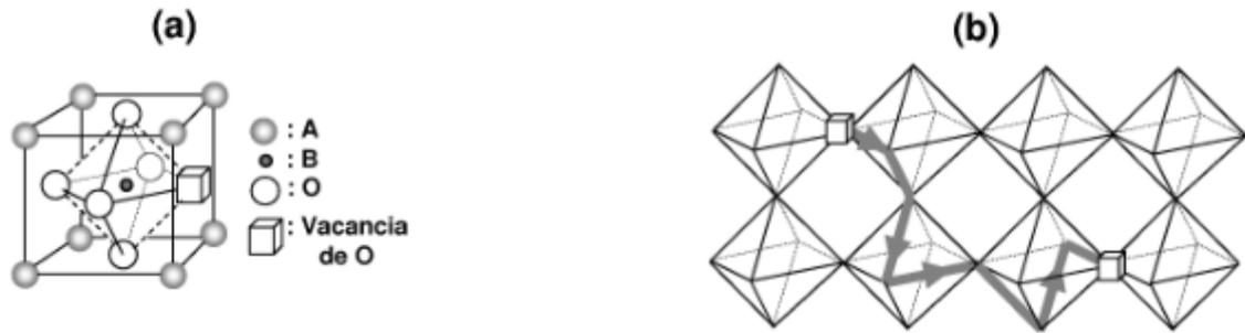
**Figura. 4.10.** (a) Estructura atómica  $ABO_{3-\delta}$  con vacancias y (b) transporte de oxígeno en una perovskita conductora mixta  $ABO_{3-\delta}$ .
