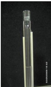
**Figura. 4.26.** Fotografía de portamuestras de cuarzo utilizado en la experimentación.
