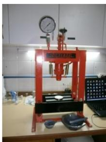
**Figura.4.11.** Fotografía de la prensa hidráulica utilizada para el prensado de las pastillas de  $\text{La}_{0.4}\text{Sr}_{0.6}\text{CoO}_{3-\delta}$ .
