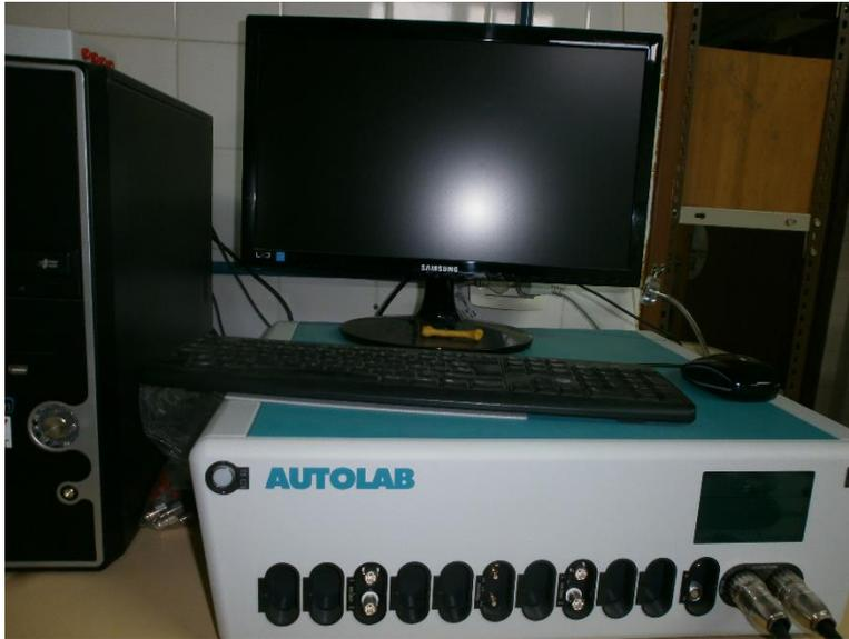
**Figura 5.4.** Fotografía del equipo de control Nova diseñado por Autolab con potencióstato / galvanómetro posee puertos USB.
