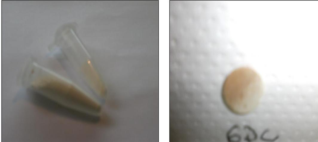
**Figura 5.16.** Fotografía de polvos y discos denso de  $\text{Ce}_{0.9}\text{Gd}_{0.1}\text{O}_{1.9}$  (GDC) sinterizados a 1550 °C.
