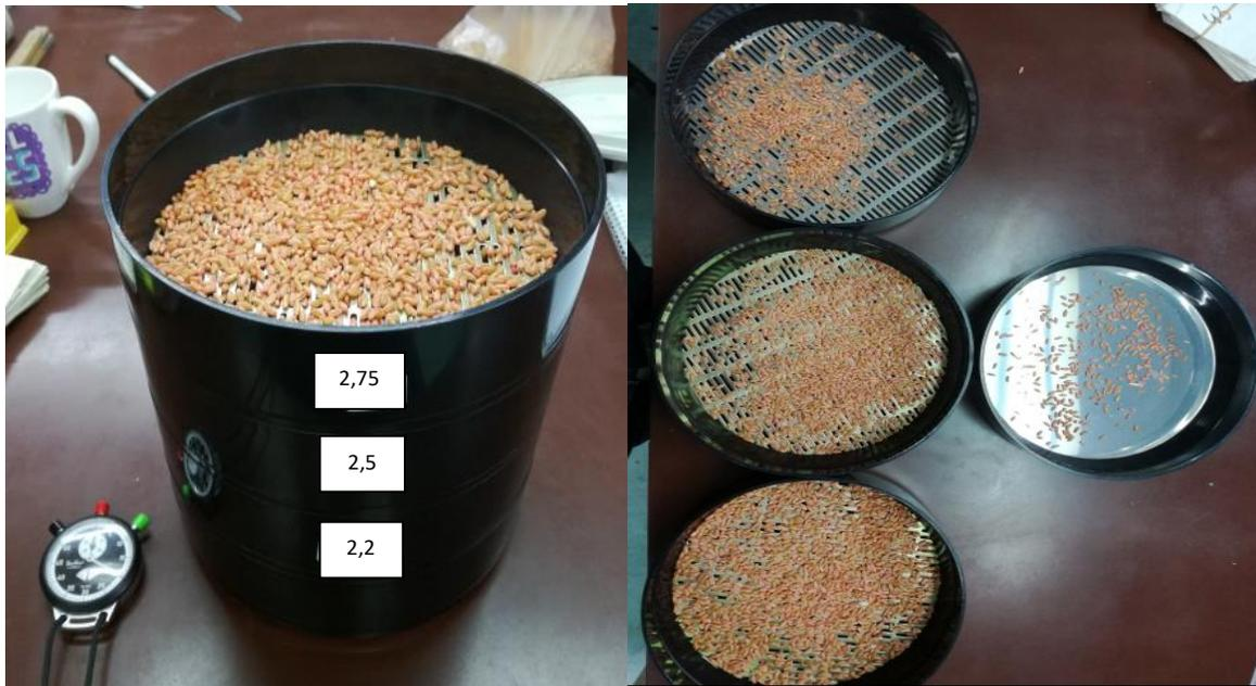
**Figura 2:** Sistema de tamices ensamblados para la determinación del calibre de la semilla.
