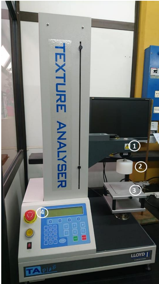
Figura 2.6. Analizador de Textura TA Plus utilizado para la evaluación de la textura de las gomas masticables desarrolladas.
