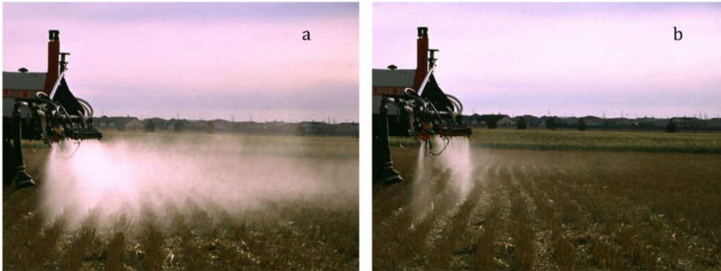
**Figura 1.5.** Pulverización agrícola a) con deriva y b) deriva reducida mediante acciones correctivas (fotografía reproducida con permiso de Tom Wolf, Fuente: [www.sprayers101.com](http://www.sprayers101.com)).
