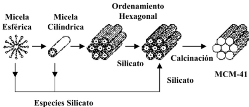
**Figura 2.3.** Esquema general de la preparación de un material mesoporoso, MCM-41
