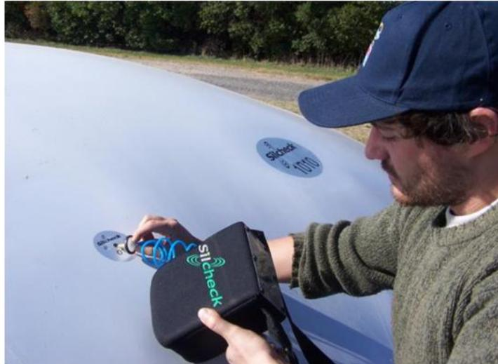
**Figura 132.** Medición de CO<sub>2</sub> con el sistema *Silcheck*, donde se observa la identificación de la bolsa y del sitio de muestreo.
