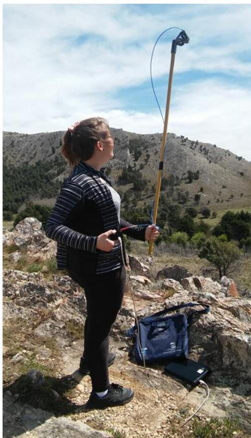
**Figura 6.3.** Adquisición de firmas espectrales con el radiómetro Ocean Optics USB2000+.
