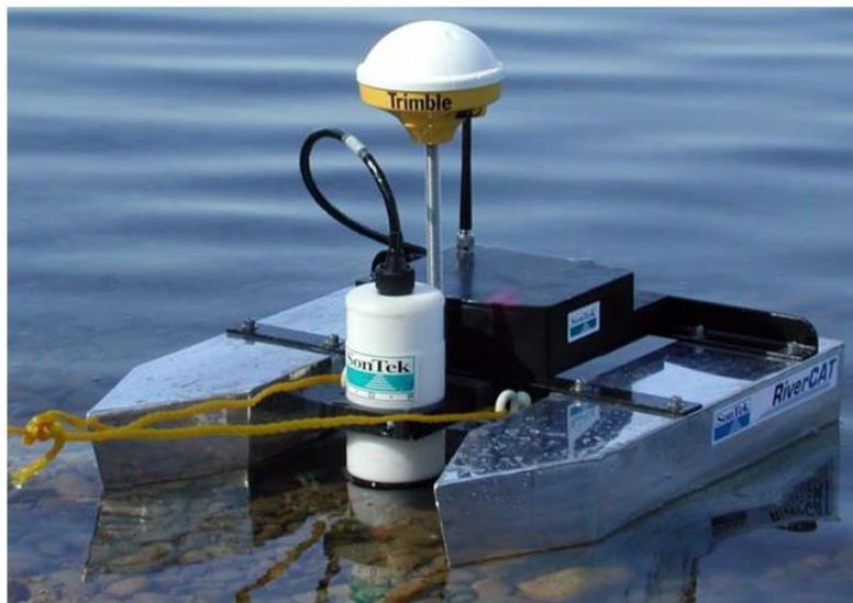
**Figura 3.4.** Perfilador de corrientes acústico Doppler (ADP) utilizado en las campañas de aforo.
