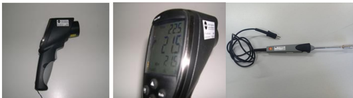
Figura 2.5.1. Termómetro infrarrojo Testo. Se observa el cuerpo del termómetro, la pantalla y la sonda de temperatura para controlar la temperatura del aire.
