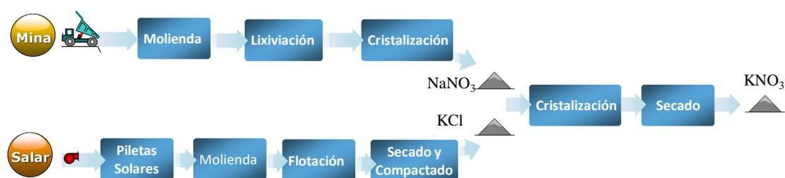
**Figura 1.4.** Diagrama de flujo del proceso de obtención de nitrato de potasio (SQM, 2016a).
