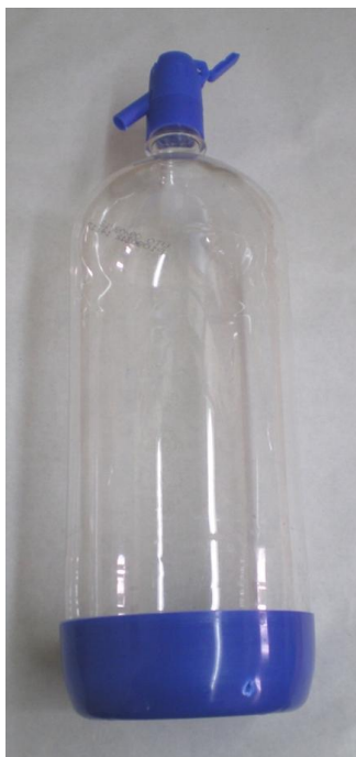
Figura 11 Sifón plástico utilizado como biorreactor.
