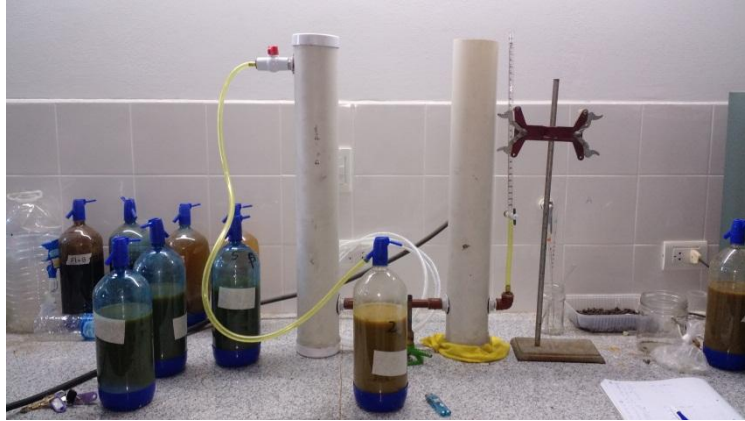
Figura 12 Columna de agua realizada con tubos de PVC para medir la cantidad de gas producido en los biorreactores.
