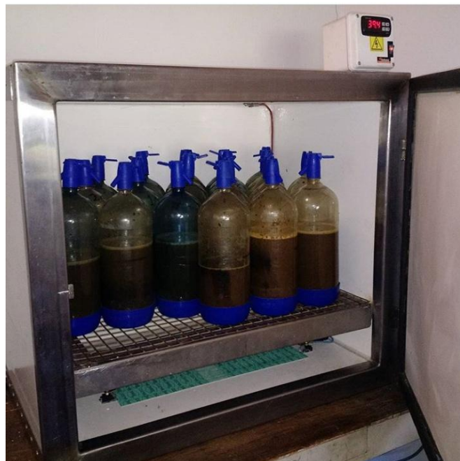
Figura 17 Estufa de cultivo utilizada en Arano. La misma fue construida por diseño propio teniendo en cuenta las características de la utilizada en el laboratorio de la UNS.
