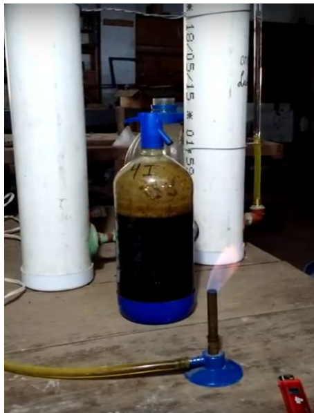
Figura 13 Mechero Bunsen utilizado para quemar el gas recolectado y ver la calidad de la llama.
