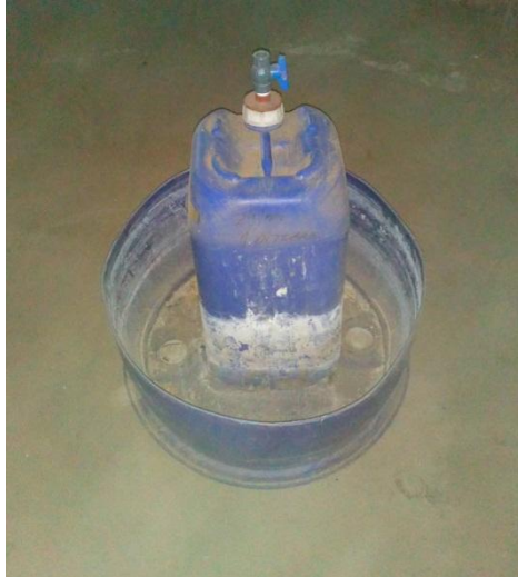
Figura 10 Bidón de 20 L donde se adaptó al tapón una canilla que permite el venteo del gas hacia el exterior. El mismo se encuentra dentro en un recipiente plástico proveniente de un tambor de 200 L de capacidad.
