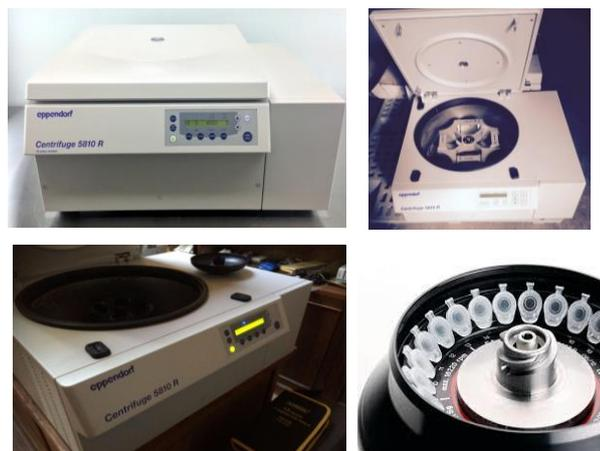
**Figura 57.3.** *Equipo para centrifugación.* Se utilizó una centrifuga refrigerada marca Eppendorf 5810R para el aislamiento de RNA, la cual permite alcanzar una velocidad superior a 12000 rpm a  $4^{\circ}\text{C}$ .
