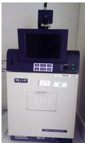
**Figura 65.3.** Transluminador UV. Se empleó un transluminador marca Benchtop 2UV para verificar la presencia de bandas 28S y 18S del rRNA y corroborar su integridad en los estudios de expresión génica del fenotipo tumoral mamario .
