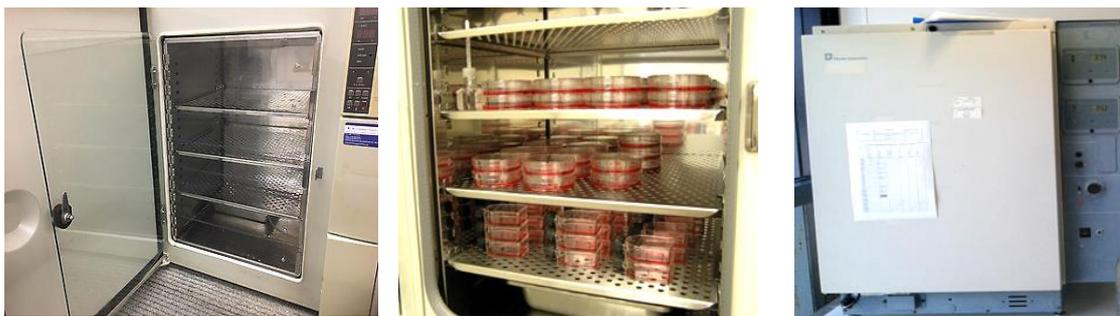
**Figura 6.3.** *Incubación celular.* La misma se realizó en una estufa de cultivo marca Sanyo, modelo MCO 175 (Sanyo Electric, Osaka, Japón), empleada para el cultivo de las líneas celulares mamarias humanas y murinas, empleando para ello una temperatura de 37°C en atmósfera controlada de 5% CO<sub>2</sub>/aire, saturada de humedad.
