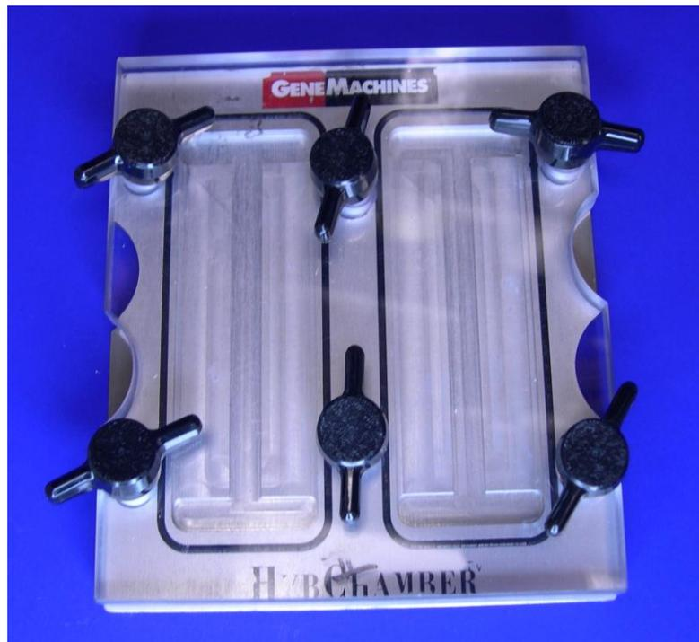
**Figura 72.3.** Cámara de hibridación del microarreglo. Se emplearon las de la Compañía GeneMachines. La cámara contiene un espacio para la hibridación simultánea de dos microarreglos. Cada slide de vidrio fue hibridizado con las sondas fluorescentes previamente sintetizadas.
