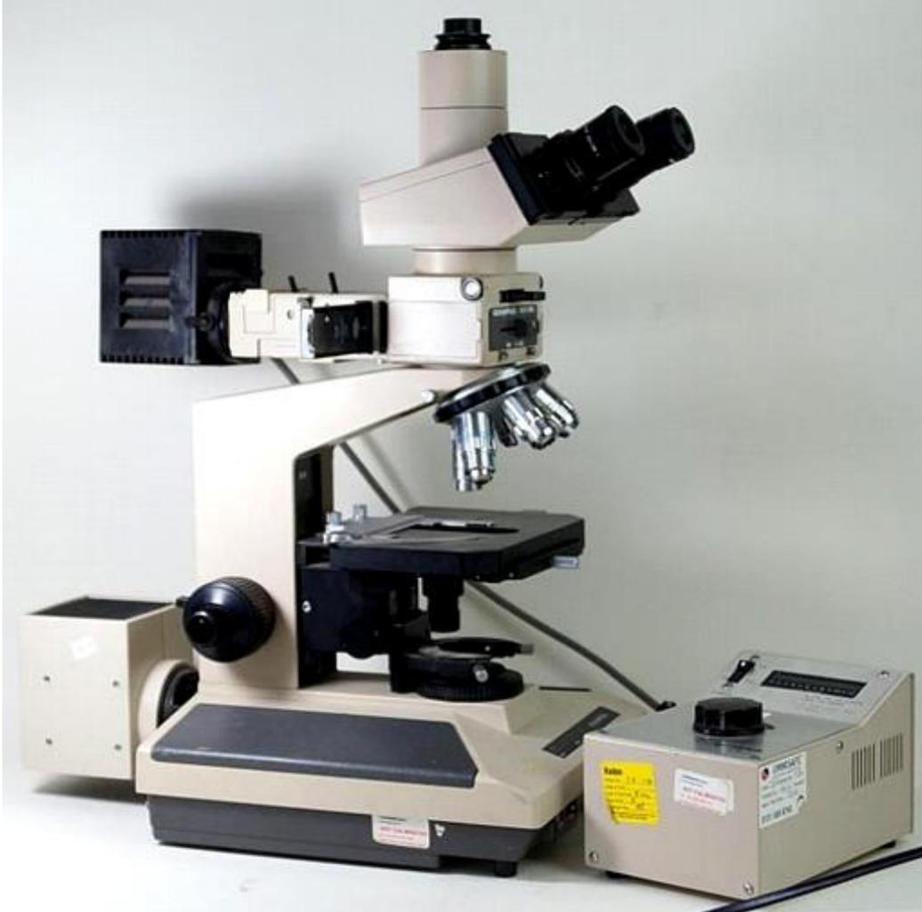
**Figura 25.3.** *Microscopio óptico de fluorescencia.* El mismo es de la marca Olympus, BH-2, UK, y se empleó para detectar la inmunofluorescencia generada por la rotura de las hebras de DNA internucleosomal durante el proceso apoptótico de células tumorales mamarias tratadas con Maitake Standard .
