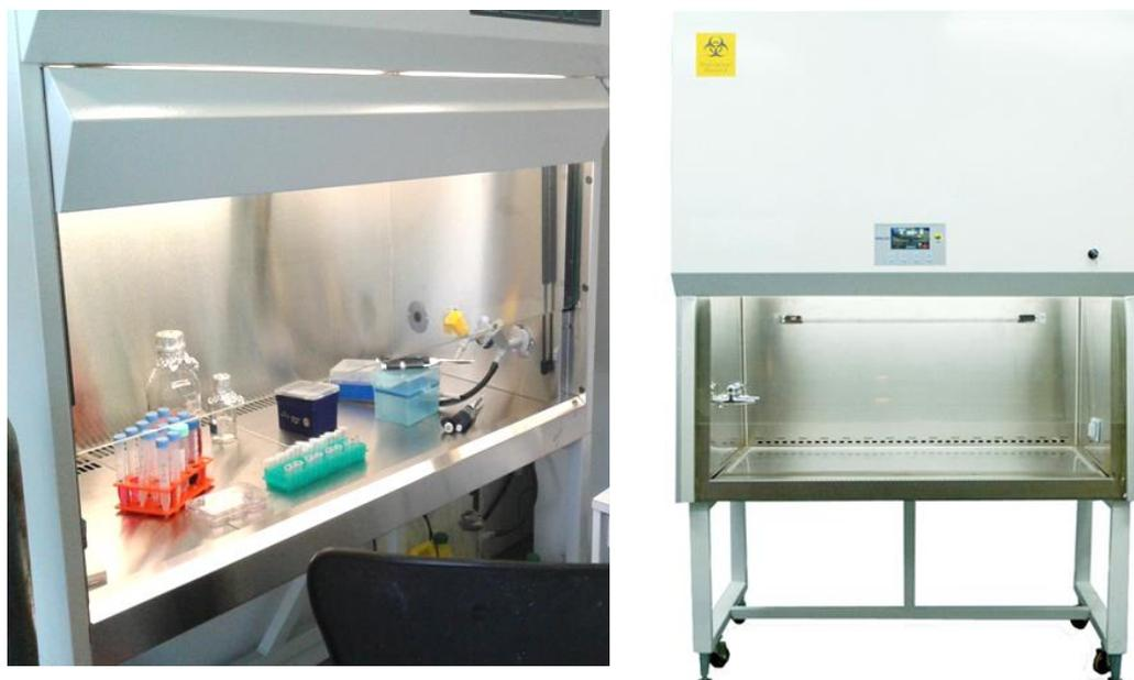
**Figura 7.3.** *Manipulación de las líneas celulares en condiciones de esterilidad.* Se empleó una cabina de flujo laminar Class 2 A/B3 Biological Safety Cabinet. Forma Scientific, la cual se empleó para realizar el cultivo celular de las líneas mamarias humanas y murinas, bajo condiciones de esterilidad, previa desinfección con etanol 70% v/v y descontaminación con luz UV durante 15 minutos.
