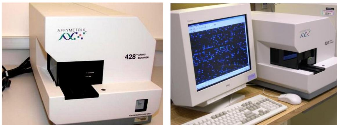
**Figura 75.3.** Revelado de los microarreglos de cDNA. Detalle del escáner marca Affymetrix 428 (izquierda) y del escáner asociado a un ordenador (derecha), a partir del cual se realizó el revelado de genes hibridizados en los microarreglos, generando resultados que posteriormente fueron analizados e interpretados por el operador.
