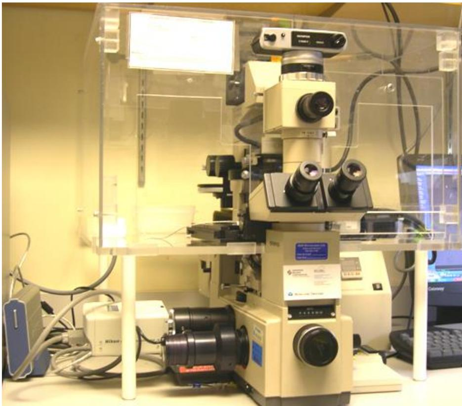
**Figura 23.3.** *Microscopio time-lapse.* El mismo permitió la monitorización de cultivos de células tumorales MCF-7 tratadas por 24 h con concentraciones crecientes de Maitake Standard. Para ello se tomaron microfotografías a intervalos preprogramados de diez minutos durante 24 h, obteniéndose una secuencia de video de la cual se extrajeron datos morfológicos, dinámicos y cuantitativos.
