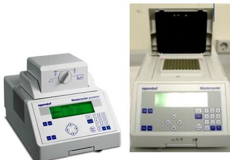
**Figura 68.3.** Reacción de retrotranscripción. La misma se completó en termociclador marca Mastercycler gradient (Eppendorf) a 40°C durante 60 min.
