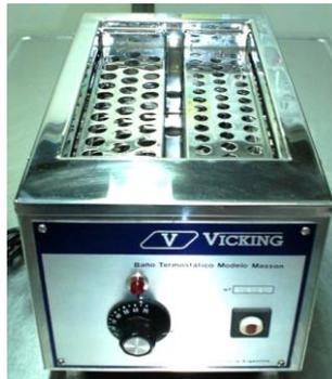
**Figura 66.3.** Baño termostático. Se empleó un baño modelo Masson marca Vicking para el shock térmico de las muestras murinas, calentadas a 70°C e inmediatamente enfriadas a 4°C.
