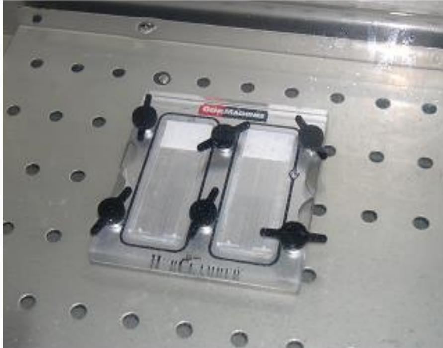
**Figura 73.3.** Hibridación de los microarreglos de cDNA. La imagen muestra la incubación en el baño de agua a 42°C durante 16 h -20 h con el microarreglo hacia arriba. La cámara fue cerrada con su tapa ajustando correctamente a fin de evitar la entrada de agua del baño.
