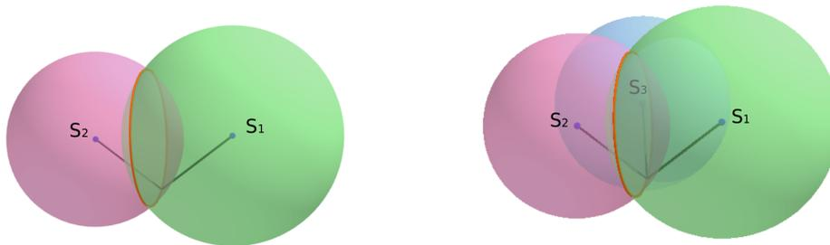
Figura 3.4: Los puntos de la intersección de las esferas centradas en los satélites  $S_1$  y  $S_2$  forman una circunferencia.
