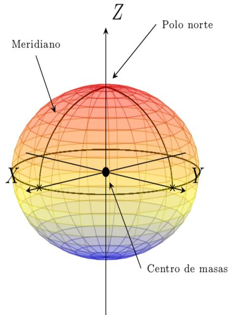
Figura 3.1: Sistema de referencia del WGS84. La circunferencia dibujada corresponde al plano ecuatorial, perpendicular a la dirección del polo norte. Y el meridiano atravesado por el eje X es el de Greenwich.
