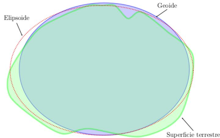
Figura 3.2: Comparación de la superficie de la tierra, el geoide y el elipsoide.
