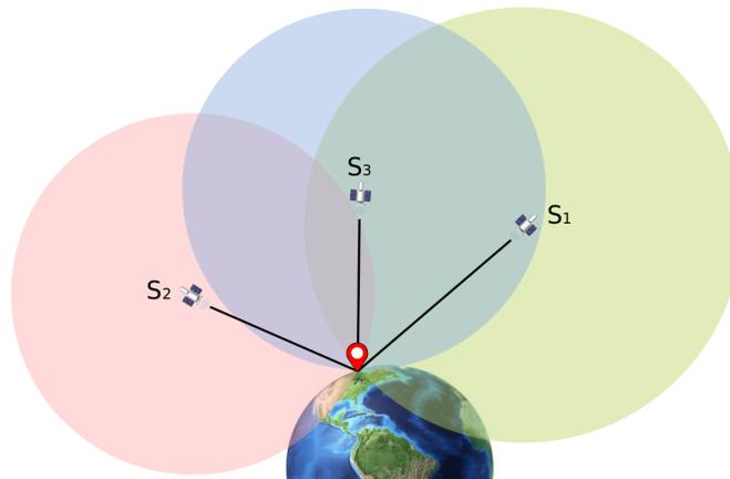
Figura 3.3: La ubicación del receptor en el espacio tridimensional se determina por la intersección de las esferas formadas por las distancias a tres satélites.
