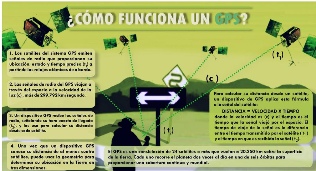
Figura 1.4: Descripción del funcionamiento del GPS.
