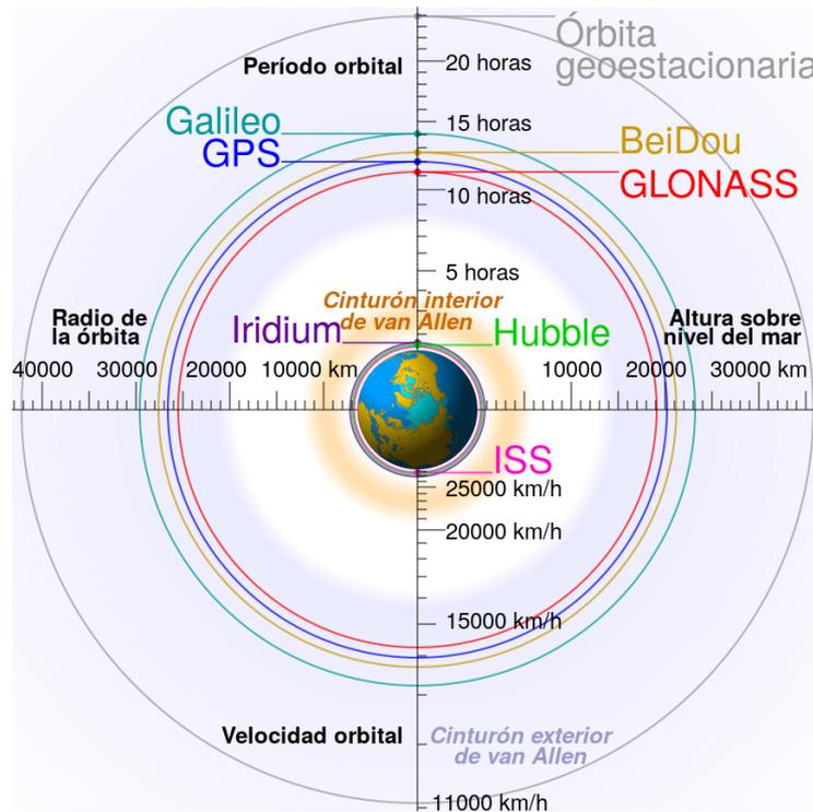
Figura 1.1: Órbita geoestacionaria, órbita de los grupos de satélites de navegación satelital, satélites de comunicación (Iridium), telescopio espacial Hubble y Estación Espacial Internacional (ISS, por sus siglas en inglés).
