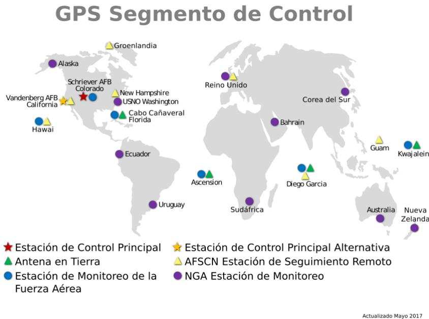
Figura 1.3: Red global de estaciones en tierra de rastreo, monitoreo, análisis y control de datos.
