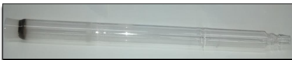
Figura 16. Reactor de pirólisis.
