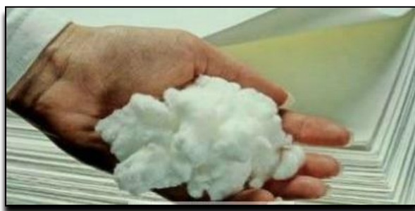
Figura 13. Pulpa de papel obtenida luego del proceso Kraft.
