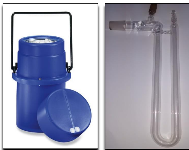
Figura 17. Termo con nitrógeno líquido donde se sumerge la trampa de vidrio en forma de U.
