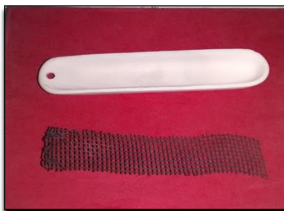
Figura 19. Navecilla cerámica y malla de acero.
