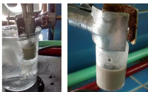
Figura 4.1 Sonicación de un sedimento contaminado con PAHs en 1-BTBr 0,2 mM.
