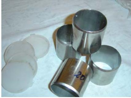
Imagen N° 14: Cilindros para la extracción de muestras con objeto de analizar su densidad aparente.
