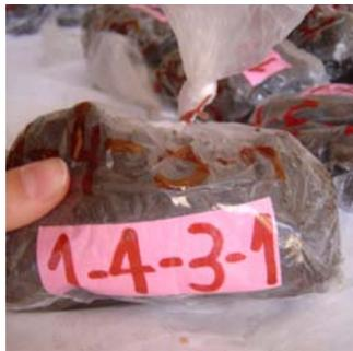
Imagen N° 22: Muestra del Lote 1, Bloque 4, Repetición 3 a una profundidad de 10 a 20 cm. Se observa el nudo y el precinto colocado para evitar la contaminación de la muestra o posibles pérdidas de suelo.
