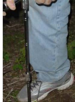
Imagen N° 11: Extracción mediante la utilización de un barreno con sacabocados. Los residuos superficiales son desplazados previamente.
