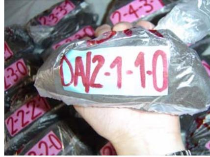
Imagen N° 21: Muestra para analizar densidad aparente del Lote 2, Bloque 1, Repetición 1 a una profundidad de 0 a 10 cm.
