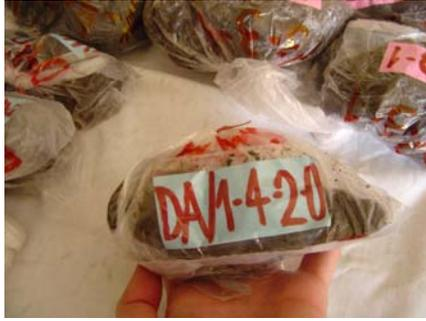
Imagen N° 20: Muestra para analizar densidad aparente del Lote 1, Bloque 4, Repetición 2 a una profundidad de 0 a 10 cm.
