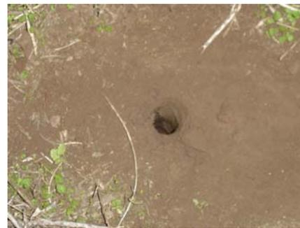
Imagen N° 13: Superficie de suelo luego del muestreo. La imagen presenta el agujero originado por la penetración con el barreno.
