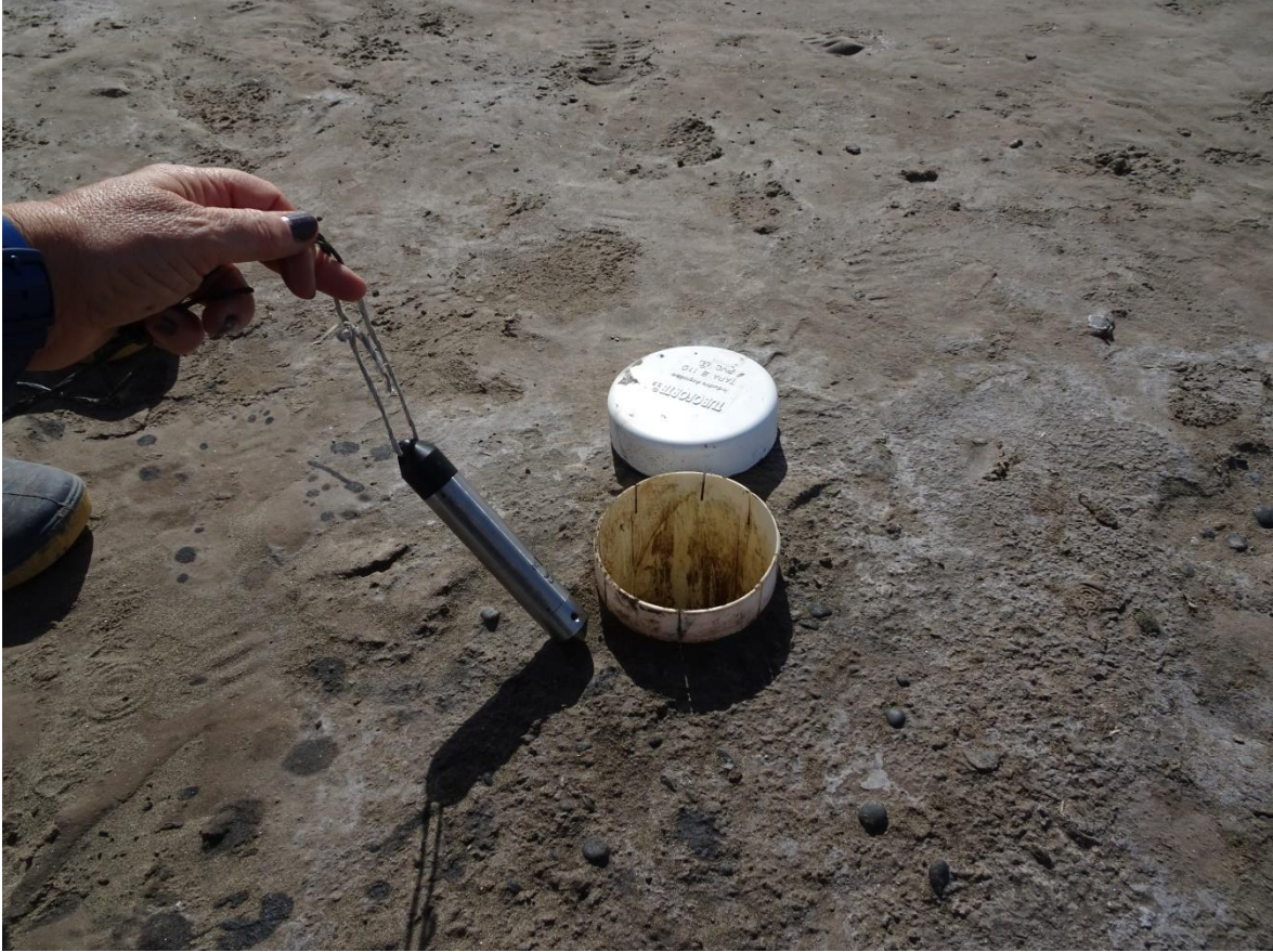
Figura 4. Sensor de nivel del agua HOBO-ONSET, modelo U20 y tubo de PVC ranurado donde se coloca el mismo.
