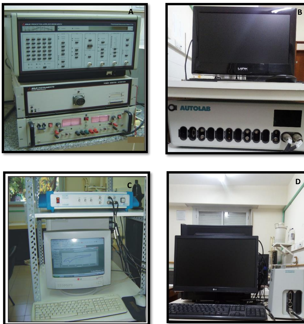
Figura 2.2. Fotografías del equipamiento electroquímico utilizado: (A) Potenciostato-Galvanostato PAR modelo 273A, (B) Potenciostato-Galvanostato Autolab/PGSTAT204, (C) Votalab 40 Potenciostat PGZ301 y (D) Potenciostato-Galvanostato Autolab/ PGSTAT128N.
