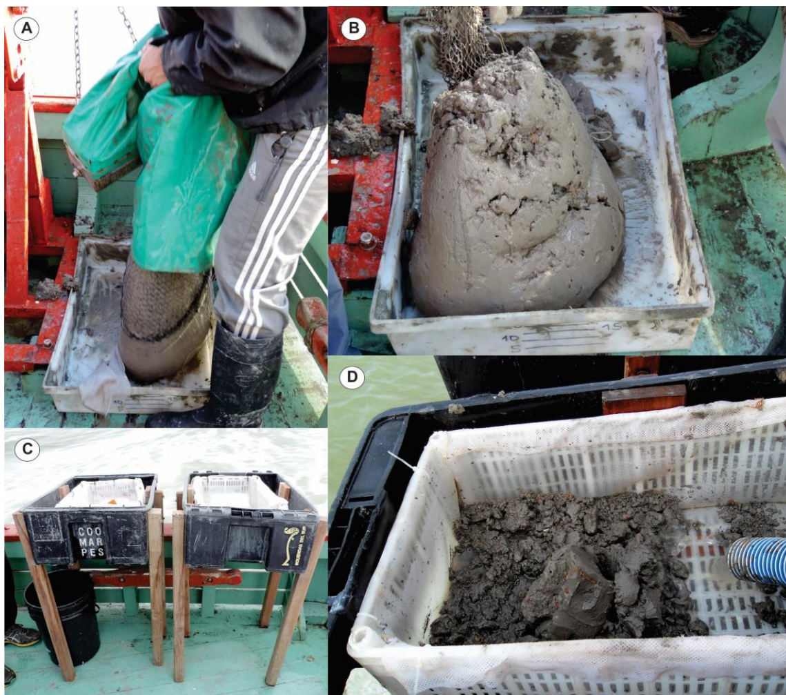
Figura 11. Muestreo biológico. A) Obtención de muestra con rastra, B) Muestra completa obtenida con rastra, C) Tamices de 0,5 mm utilizados a bordo D) Tamizado de muestra a bordo.
