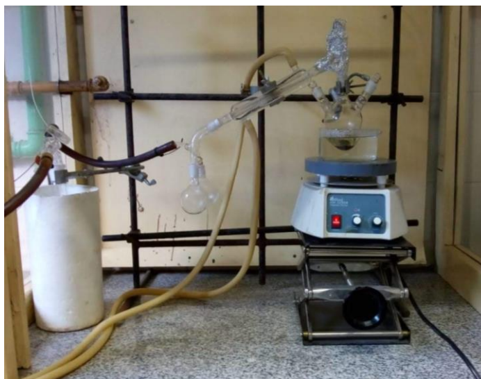
Figura 2.3: Tren utilizado para la destilación de Py.
