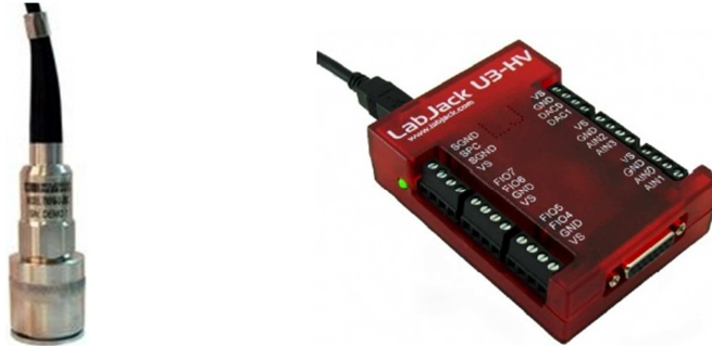
Figura 3.2 - Acelerómetro Wilcoxon Research 780C y adquisidora de datos LabJack U3-HV utilizados para las mediciones de vibración del motor.
